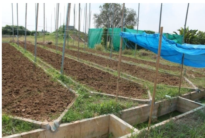
ภาพที่ 24 แปลงทดลองการชะล้างพังทลายของดิน
