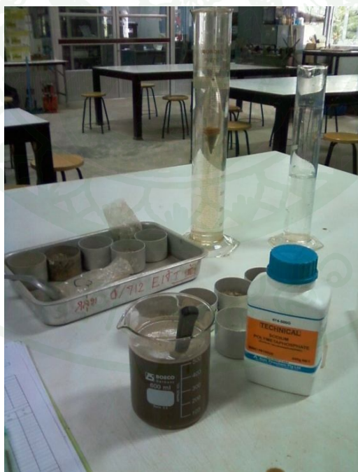
ภาพที่ 16 ชุดเครื่องมือหาขนาดเม็ดดินแบบตกตะกอน
