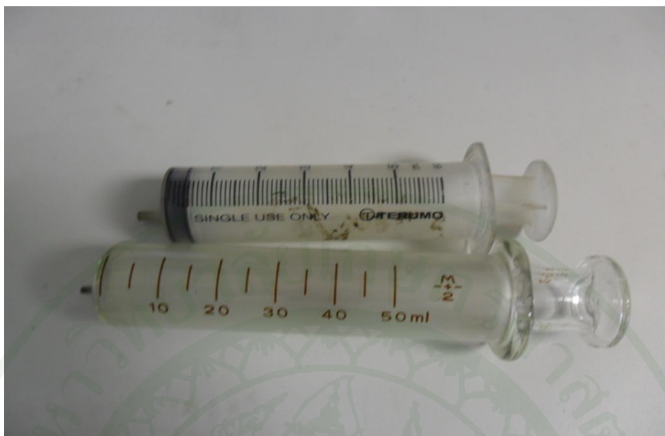
ภาพที่ 10 หลอดและเข็มฉีดยาสำหรับดึงแก๊สตัวอย่างมาเก็บในขวด
