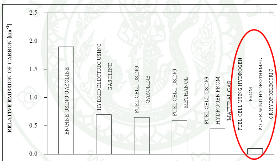
ภาพที่ 2 เปรียบเทียบการปลดปล่อยคาร์บอนระหว่างเครื่องยนต์ที่ใช้ไฮโดรเจนกับเครื่องยนต์ที่ใช้เชื้อเพลิงชนิดอื่น
