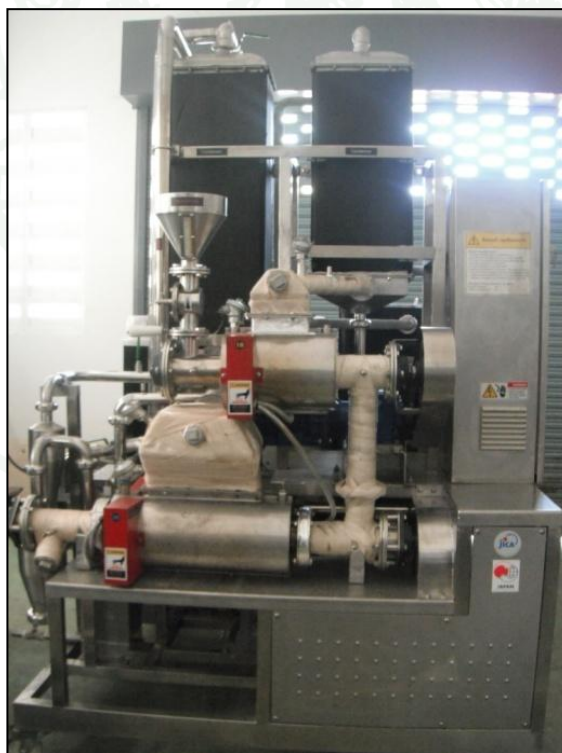
ภาพที่ 13 ภาพถ่ายปฏิกรณ์ไพโรไลซิสแบบสกรูสองขั้นตอน
