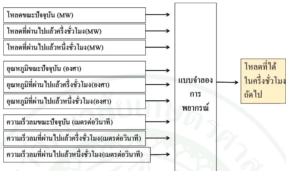
ภาพที่ 14 ข้อมูลที่ใช้ในการสร้างแบบจำลองพยากรณ์โหลดระยะสั้นแบบพหุคูณ
