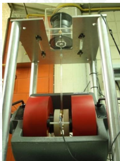
ภาพที่ 37 แมกนีโตมิเตอร์แบบสั้นตัวอย่าง (VSM)
