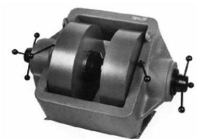
ภาพที่ 36 เครื่องกำเนิดสนามแม่เหล็กไฟฟ้าของบริษัท Walker Scientific Inc. รุ่น HV-4H
