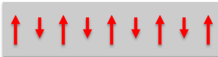
ภาพที่ 13 โมเมนต์แม่เหล็กภายในวัสดุแม่เหล็กเฟอร์ริ
