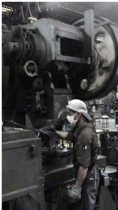
ภาพที่ 33 แสดงพนักงานนำก้อนทองเหลืองที่ได้รับความร้อนแล้วไปวางบนแม่พิมพ์
