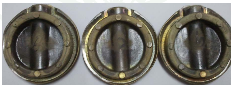
ภาพที่ 125 ชิ้นงานล้นประตุน้ำ (GT50) ที่ได้จากการทดสอบการทุบขึ้นรูปจาก Billet น้ำหนัก 1.15 เตะ
