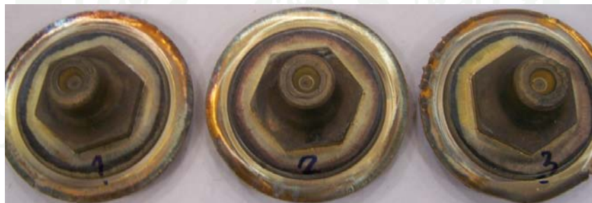
ภาพที่ 72 ตัวอย่างชิ้นงานฝาประตุน้ำ (VC50) หลังการทุบขึ้นรูป ของ 3 ตัวอย่างชิ้นงาน
