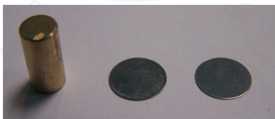
ภาพที่ 46 แสดงชิ้นงานทองเหลืองสำหรับการทดสอบสมบัติทางกลของวัสดุและวัสดุสำหรับใช้รองลิ้นเพื่อลดความเสียหายในขณะทำการทดสอบ
