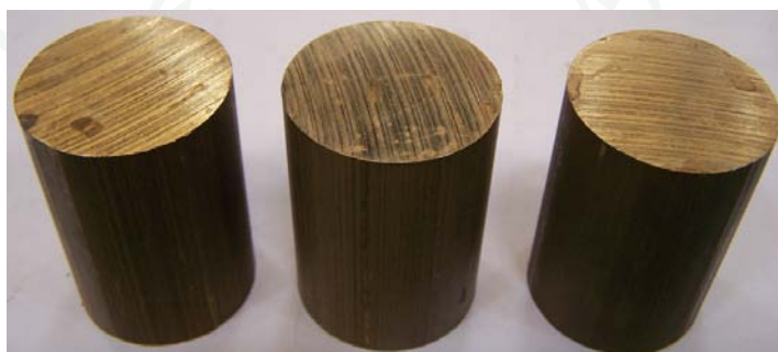
ภาพที่ 42 ชิ้นงาน (Billet) ที่ใช้สำหรับการทุบขึ้นรูปฝาขันมาตรวัดน้ำ (HC15)
