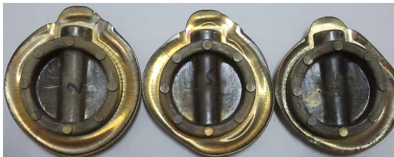
ภาพที่ 126 ชิ้นงานลึ้นประตุน้ำ (GT50) ที่ได้จากการทดสอบการทุบขึ้นรูปจาก Billet น้ำหนัก 1.2 เท่า
