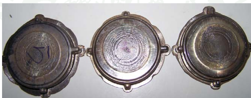
ภาพที่ 76 ตัวอย่างชิ้นงานฝาขันมาตรวัดน้ำ (HC15) หลังการทุบขึ้นรูป ของ 3 ตัวอย่างชิ้นงาน
