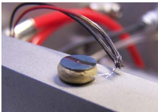
ภาพที่ 79 แสดงชิ้นงานหลังจากการทดสอบแรงอัดที่อุณหภูมิ 650°C
