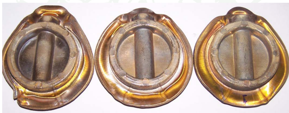
ภาพที่ 74 ตัวอย่างชิ้นงานลึ้นประตุน้ำ (GT50) หลังการชุบขึ้นรูป ของ 3 ตัวอย่างชิ้นงาน
