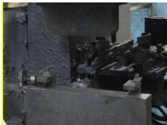
ภาพที่ 58 การติดตั้งแม่พิมพ์ที่ใช้ในการทดสอบ Ring Compression Test
