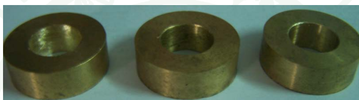
ภาพที่ 43 ชิ้นงานสำหรับการทดสอบ Ring Compression Test
