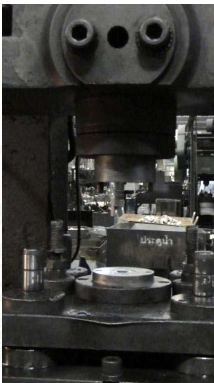
ภาพที่ 31 การติดตั้งแม่พิมพ์ตัวบนและล่างที่เครื่องทุบขึ้นรูป
