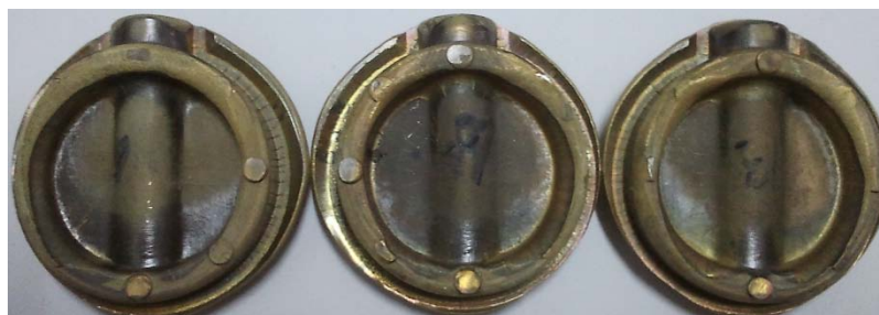
ภาพที่ 123 ชิ้นงานล้นประตุน้ำ (GT50) ที่ได้จากการทดสอบการทุบขึ้นรูปจาก Billet น้ำหนัก 1.1 เตะ
