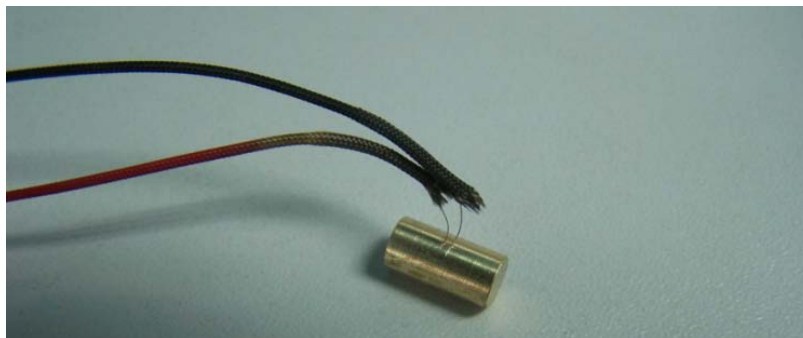
ภาพที่ 62 ชิ้นงานทดสอบที่ติดตั้ง Thermocouple แล้ว
