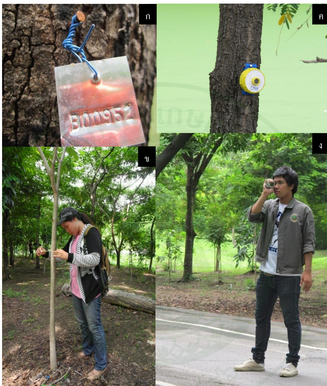
ภาพที่ 4 การเก็บข้อมูลของต้นไม้ในโครงการอุทยานสวนจตุจักร (ก) ทำการติดเครื่องหมายที่ระดับความสูงเพียงอก (ข) วัดขนาดเส้นผ่านศูนย์กลางเพียงอกด้วยเทปวัดเส้นผ่านศูนย์กลาง (ค) และ (ง) วัดความสูงทั้งหมดและความสูงถึงกิ่งสดกิ่งแรก ด้วยเครื่องมือวัดความสูง Vertex meter
