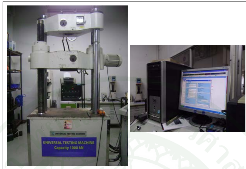
ภาพที่ 31 เครื่องทดสอบเอนกประสงค์สำหรับทดสอบกดจริง
