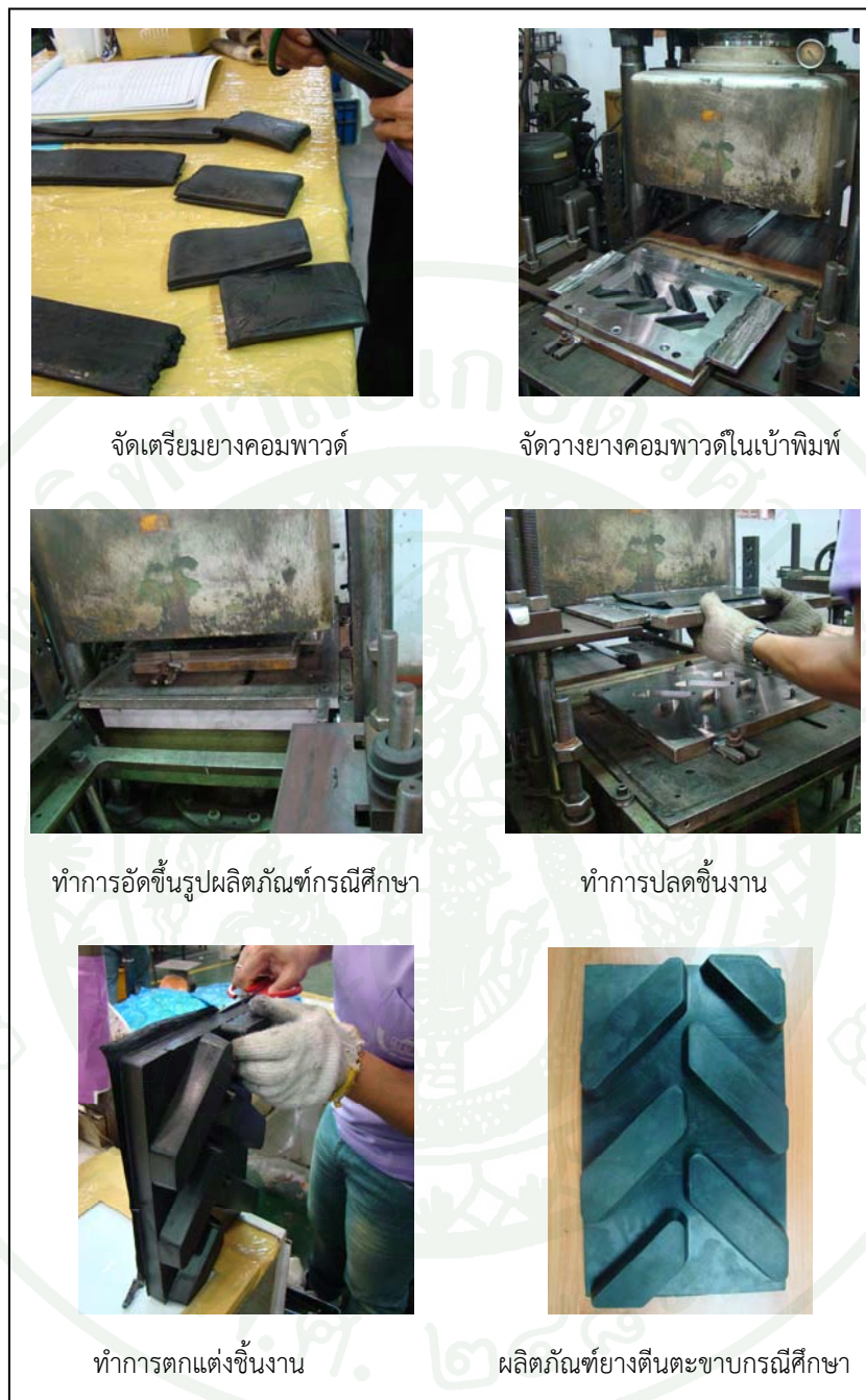
ภาพที่ 51 ขั้นตอนในการอัดขึ้นรูปผลิตภัณฑ์ยางตีนตะขากรณีศึกษา
