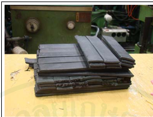
ภาพที่ 27 ยางคอมพาวด์ที่ใช้สำหรับผลิตภัณฑ์ยางตีนตะขาบกรณีศึกษา
