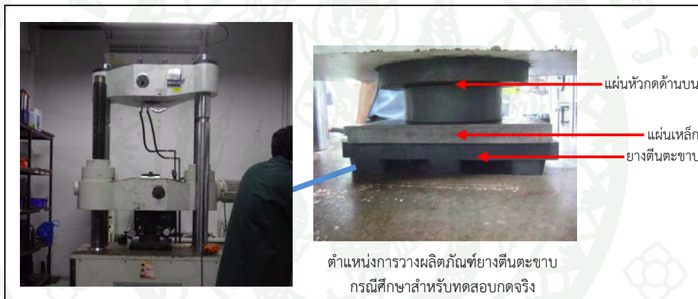
ภาพที่ 36 ทดสอบการรับแรงกดตั้งฉากที่กระทำบนผลิตภัณฑ์ยางตีนตะขาบกรณีศึกษาจริง
