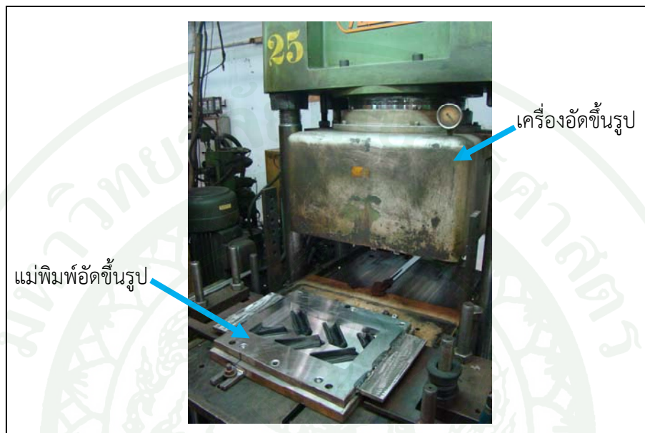
ภาพที่ 29 เครื่องอัดขึ้นรูปและแม่พิมพ์อัดขึ้นรูปผลิตภัณฑ์ยางตีนตะขาบกรณีศึกษา
