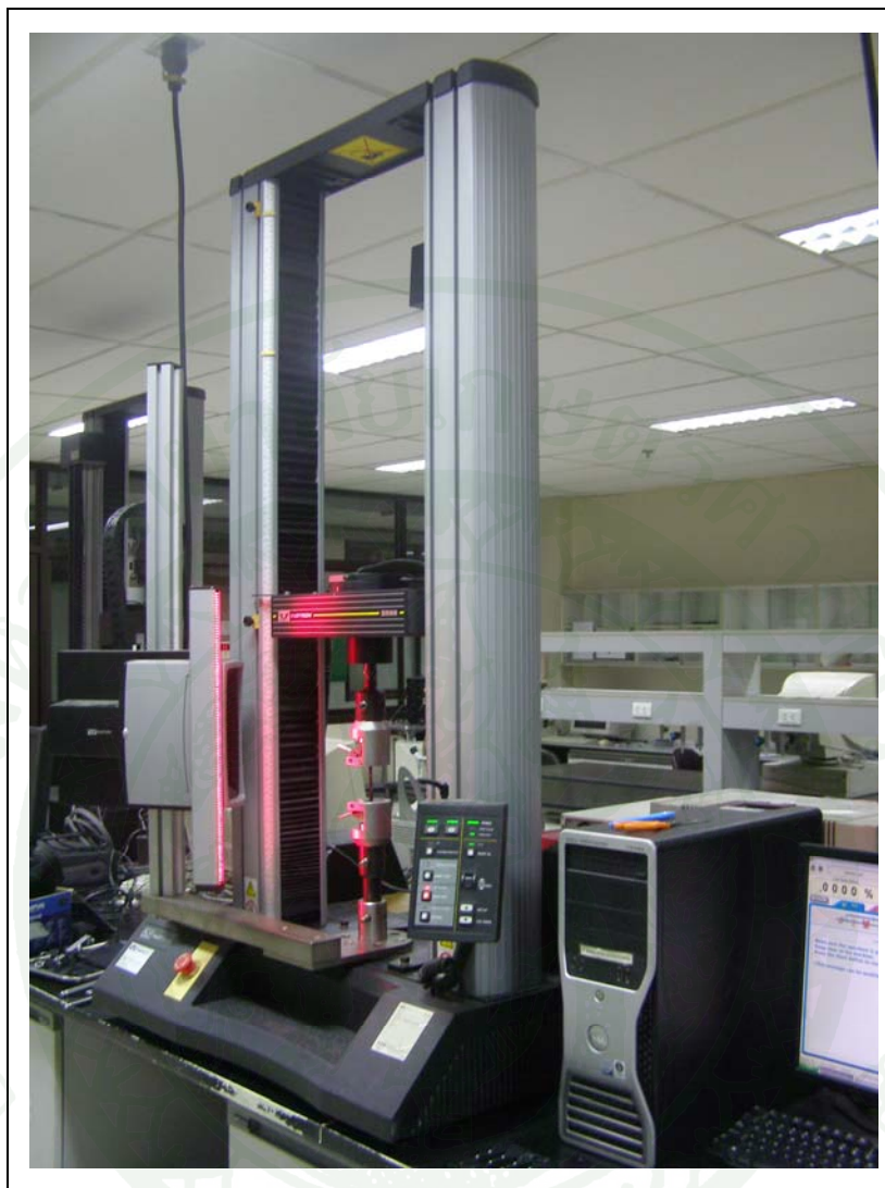
ภาพผนวกที่ ก1 เครื่องทดสอบเอนกประสงค์ รุ่น INSTRON 5566
