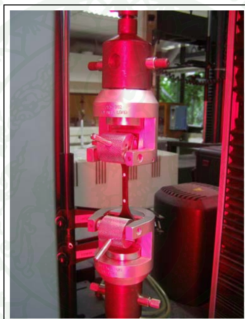
ภาพที่ 41 การทดสอบสมบัติการรับแรงดึง
