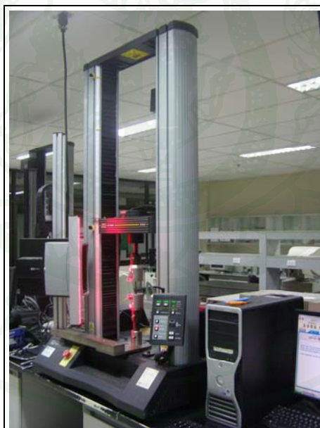
ภาพที่ 28 เครื่องทดสอบเอนกประสงค์สำหรับการสมบัติทางกลของยางคอมพาวด์
