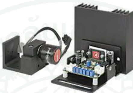
ภาพที่ 10 ส่วนประกอบของชุดปรับเปลี่ยนรูปแบบแสงเลเซอร์สำเร็จรูปและบอร์ดควบคุม
