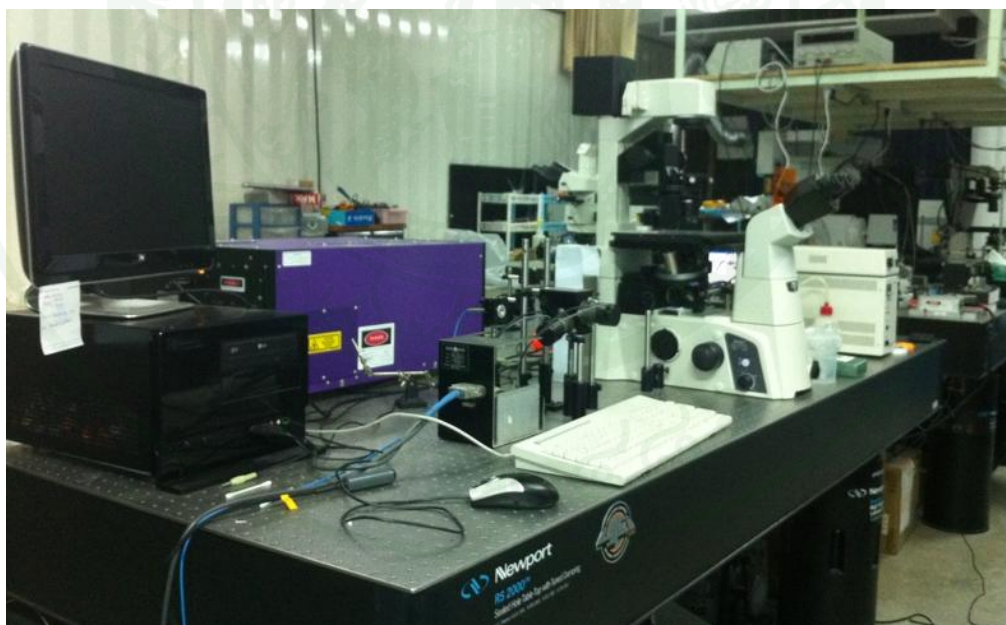
ภาพที่ 23 ชุดอุปกรณ์คีมจับเชิงแสงที่ใช้ในการทดลองศึกษารูปแบบการเจริญเติบโตของยีสต์
