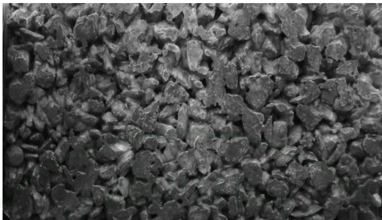
ภาพที่ 46 ลักษณะคอนกรีตพูนมวลรวมขนาดค้ำตะแกรงเบอร์ 4
