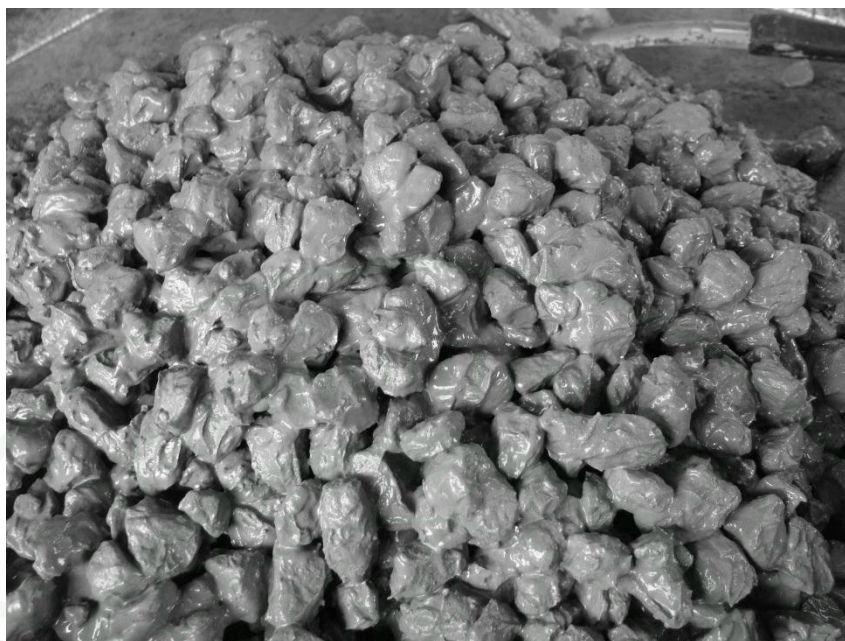
ภาพที่ 37 คอนกรีตพรุนที่ได้จากมวลรวมหยาบขนาด 3/8 นิ้ว
