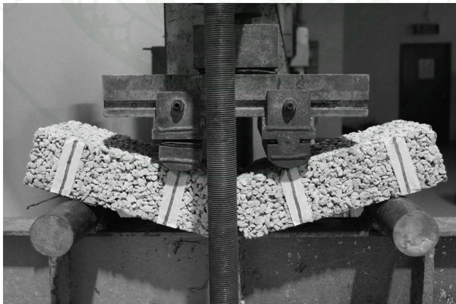
ภาพที่ 60 พฤติกรรมการวิบัติของคอนกรีตพูนที่ไม่เสริมวัสดุใยสังเคราะห์เสริมแรง
