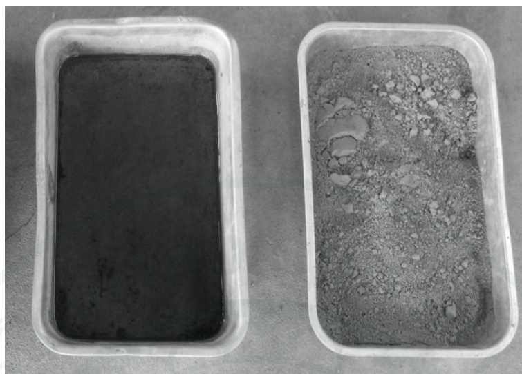
ภาพที่ 32 การเตรียมปูนซีเมนต์ สารผสมเพิ่มและน้ำเพื่อทำการผสมซีเมนต์เพสต์
