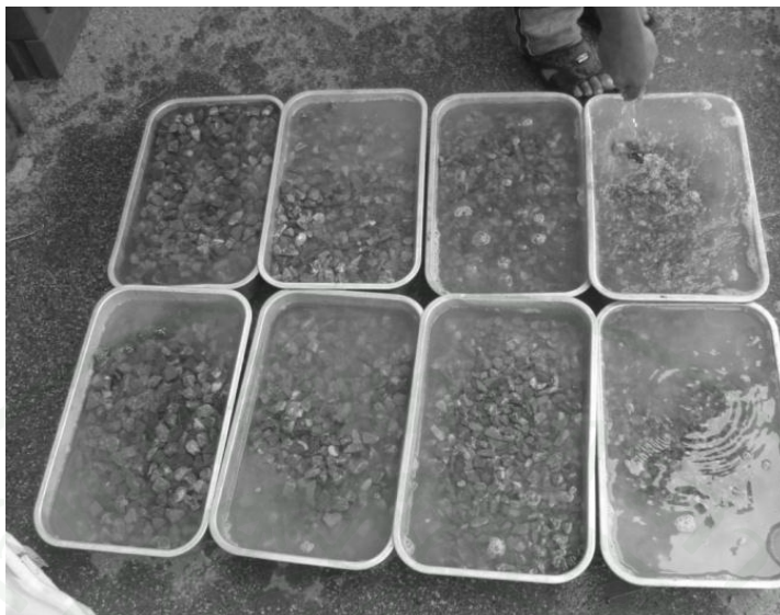
ภาพที่ 30 การแช่มวลรวมหยาบในน้ำเป็นเวลา 24 ชั่วโมง เพื่อให้มวลรวมอยู่ในสภาพอิ่มตัวด้วยน้ำ
