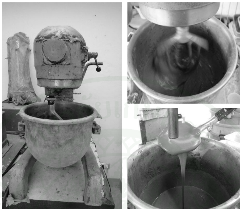
ภาพที่ 33 การผสมซีเมนต์เพสต์และลักษณะซีเมนต์เพสต์หลังจากการผสม
