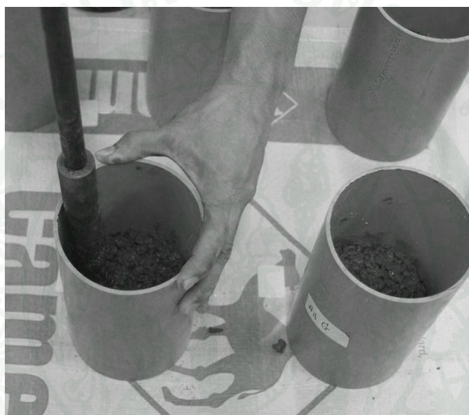
ภาพที่ 52 การหล่อตัวอย่างคอนกรีตพูนสำหรับการทดสอบ
