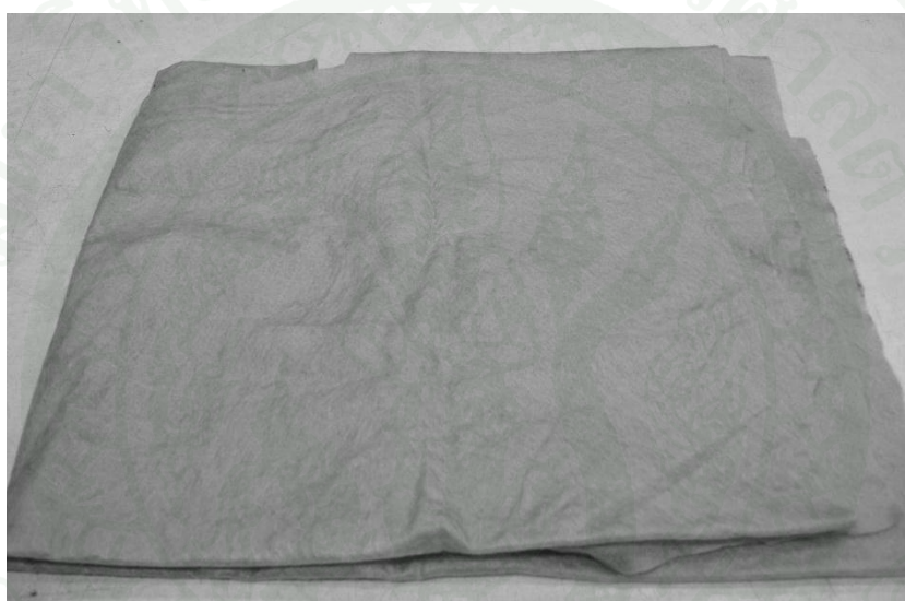
ภาพที่ 42 วัสดุใยสังเคราะห์ชนิด Geotextile ที่ใช้ในการทดสอบการกรอง
