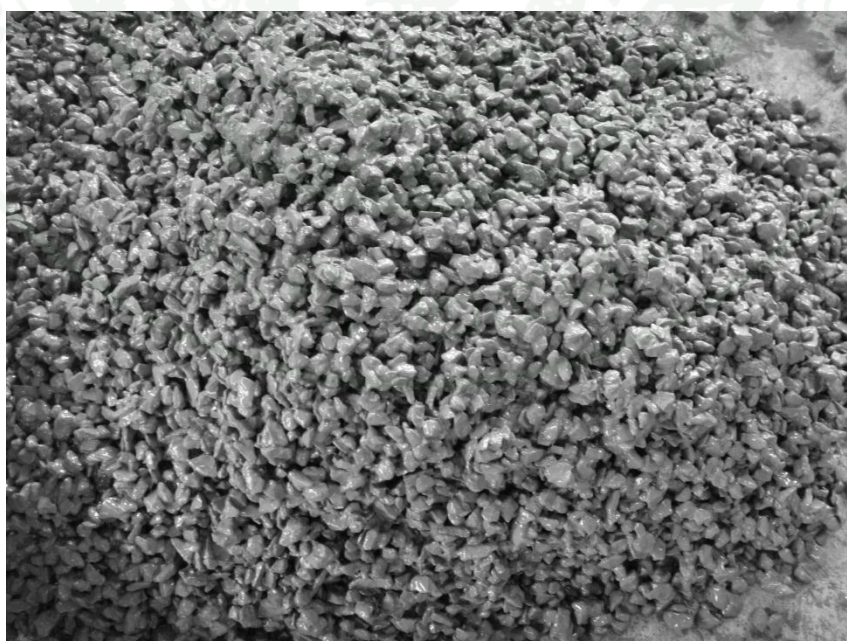
ภาพที่ 36 คอนกรีตพูนที่ได้จากมวลรวมหยาบขนาดข้างตะแกรง # 4 (4.75 มิลลิเมตร)
