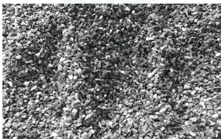
ภาพที่ 29 มวลรวมหยาบขนาดค้ำตะแกรง # 4 (4.75 มิลลิเมตร) ที่คัดขนาดแล้ว
