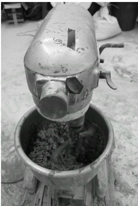
ภาพที่ 35 การผลิตคอนกรีตพูนในเครื่องผสม
