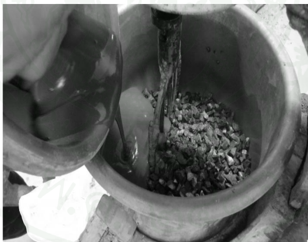
ภาพที่ 34 การเติมซีเมนต์เพสต์ผสมกับมวลรวมหยาบเพื่อผลิตคอนกรีตพูน
