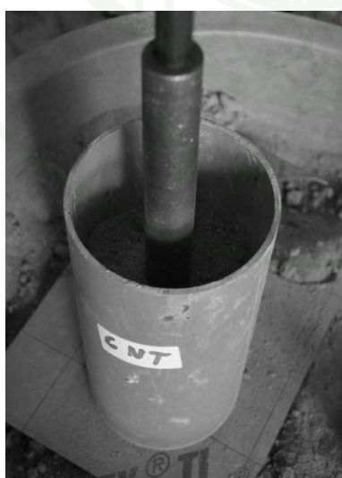
ภาพที่ 54 การบดอัดทรายลงในแบบหล่อคอนกรีตพูนที่ความหนาแน่น 1.54 ตัน/เมตร 3
