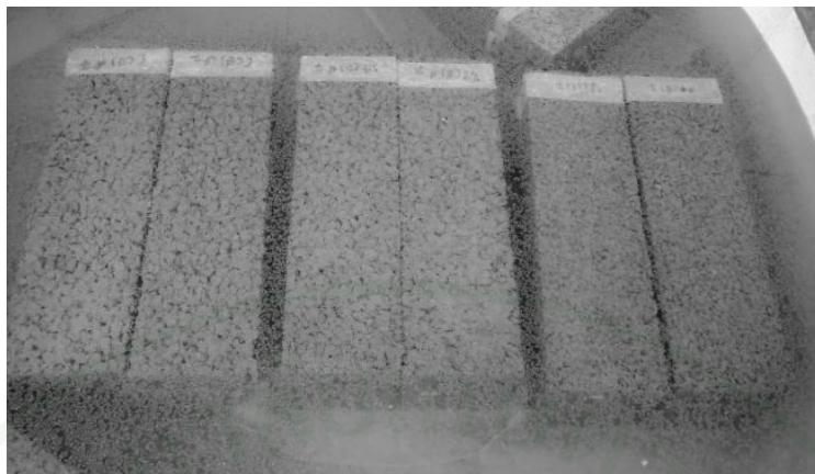
ภาพที่ 49 การบ่มคอนกรีตพูนตามอายุก่อนการทดสอบกำลังรับแรงดัด
