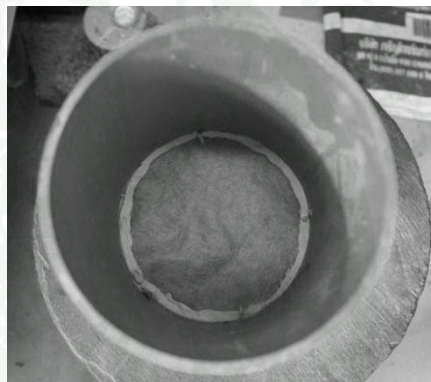
ภาพที่ 53 การประกอบ Geotextile เข้ากับแบบหล่อตัวอย่างคอนกรีตพูน
