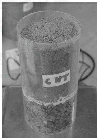
ภาพที่ 54 การบดอัดทรายลงในแบบหล่อคอนกรีตพูนที่ความหนาแน่น 1.54 ตัน/เมตร 3
