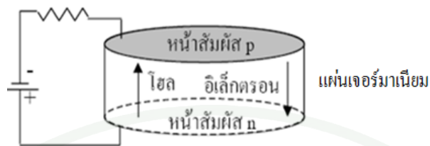
ภาพที่ 7 โครงสร้างของหัววัด HPGe แบบเพลนนา
