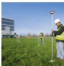
ภาพที่ 2.21 การประยุกต์เก็บข้อมูลหลักหมุดโหนดที่ดินด้วยดาวเทียมโดยวิธี RTK
