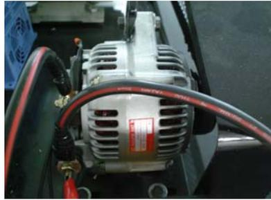
รูปที่ 3.10 อัลเทอร์เนเตอร์ ขนาด 50 แอมป์ 12 โวลต์ ที่ใช้ทดสอบ
