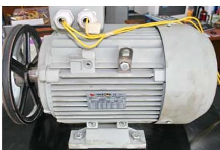
รูปที่ 3.8 มอเตอร์เหนี่ยวนำเหนี่ยวนำสำหรับใช้ขับอัลเทอร์เนเตอร์
