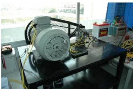
รูปที่ 3.7 ระบบทดสอบอัลเทอร์เนเตอร์-โวลต์เตจเร็กกูเลเตอร์
