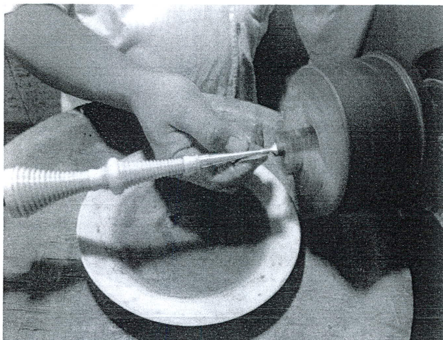
ภาพที่ ๑๖๕ การใช้กระดาศทรายน้ำขัดเงาปลายเข็มทองเหลือง
