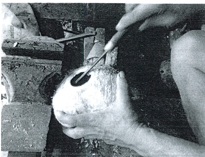
ภาพที่ ๖๙ การใช้เครื่องมือเหล็กแซะเศษเนื้อมะพร้าวที่ยังติดอยู่ออก
