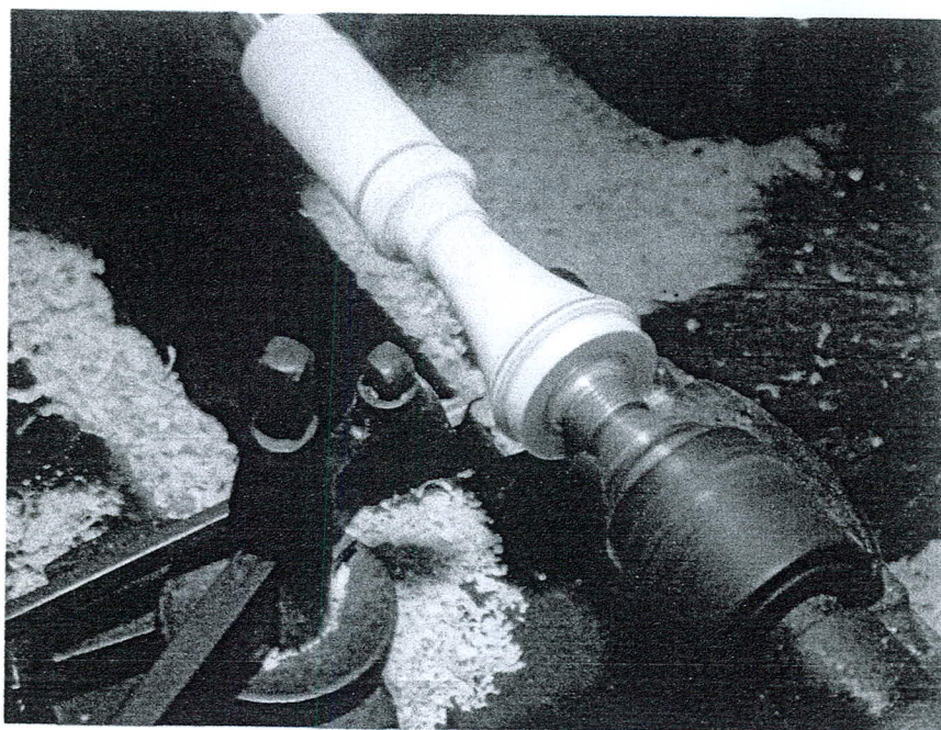
ภาพที่ ๑๖๑ การกลึงเข้ารูปให้เรียบในส่วนใต้หุ้มกะโหลก
