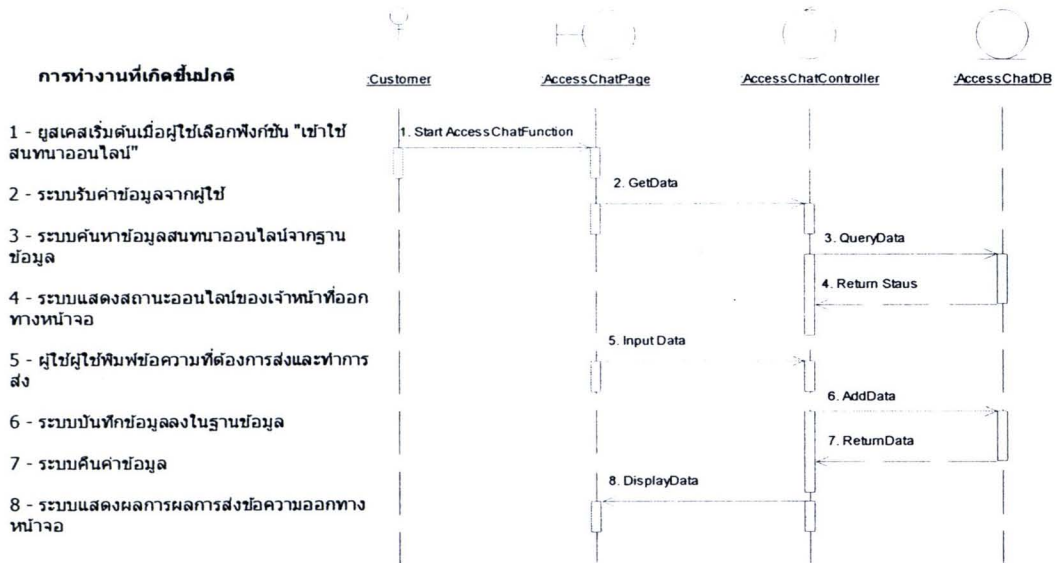
รูปที่ ข.10 ซีเควนซ์ไดอะแกรมของการเข้าใช้งานระบบสนทนาออนไลน์
