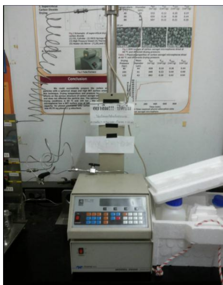
รูปที่ 3.3 ปั๊มอัดแรงดัน (รุ่น Syringe Pump Isco Model 260D)
