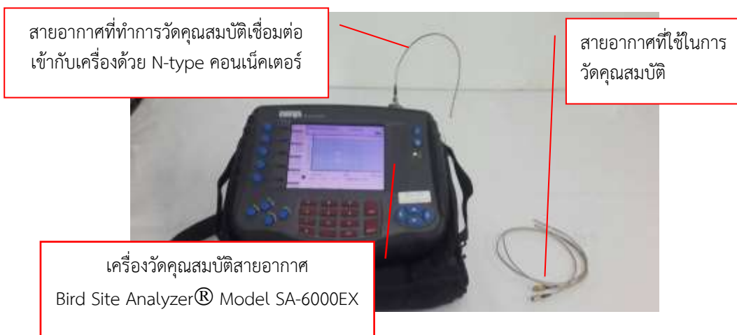
รูปที่ 3.11 เครื่องวัดคุณสมบัติสายอากาศ Bird Site Analyzer® Model SA-6000EX
