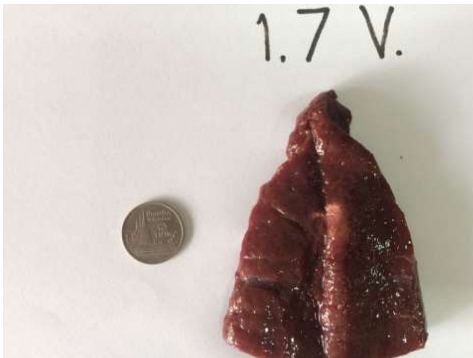
รูปที่ 4.11 การทดลอง โดยทำการทดสอบกับเครื่องทำลายเซลล์มะเร็งขนาด 1 แห่งจ่าย ปรับกำลังงาน ไฟตรงเพื่อป้อนให้กับชุด จ่ายคลื่นไมโครเวฟขนาด 1.7 โวลท์
