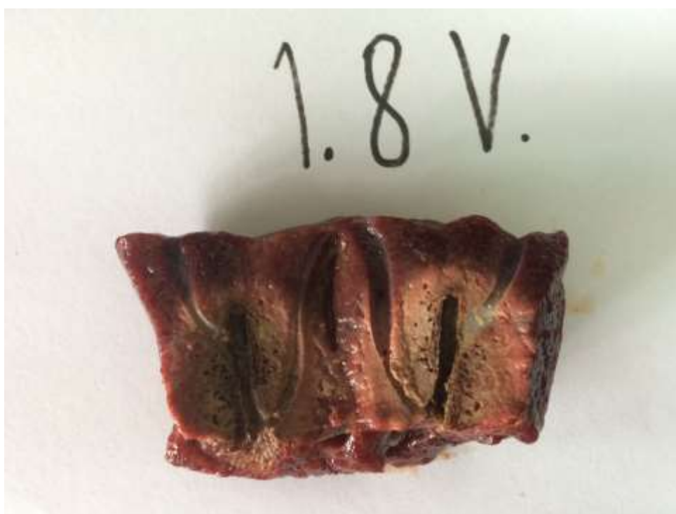
รูปที่ 4.13 การทดลอง โดยทำการทดสอบกับเครื่องทำลายเซลล์มะเร็งขนาด 1 แพล่งจ่าย ปรับกำลังงาน ไฟตรงเพื่อป้อนให้กับชุด จ่ายคลื่นไมโครเวฟขนาด 1.8 โวลท์
