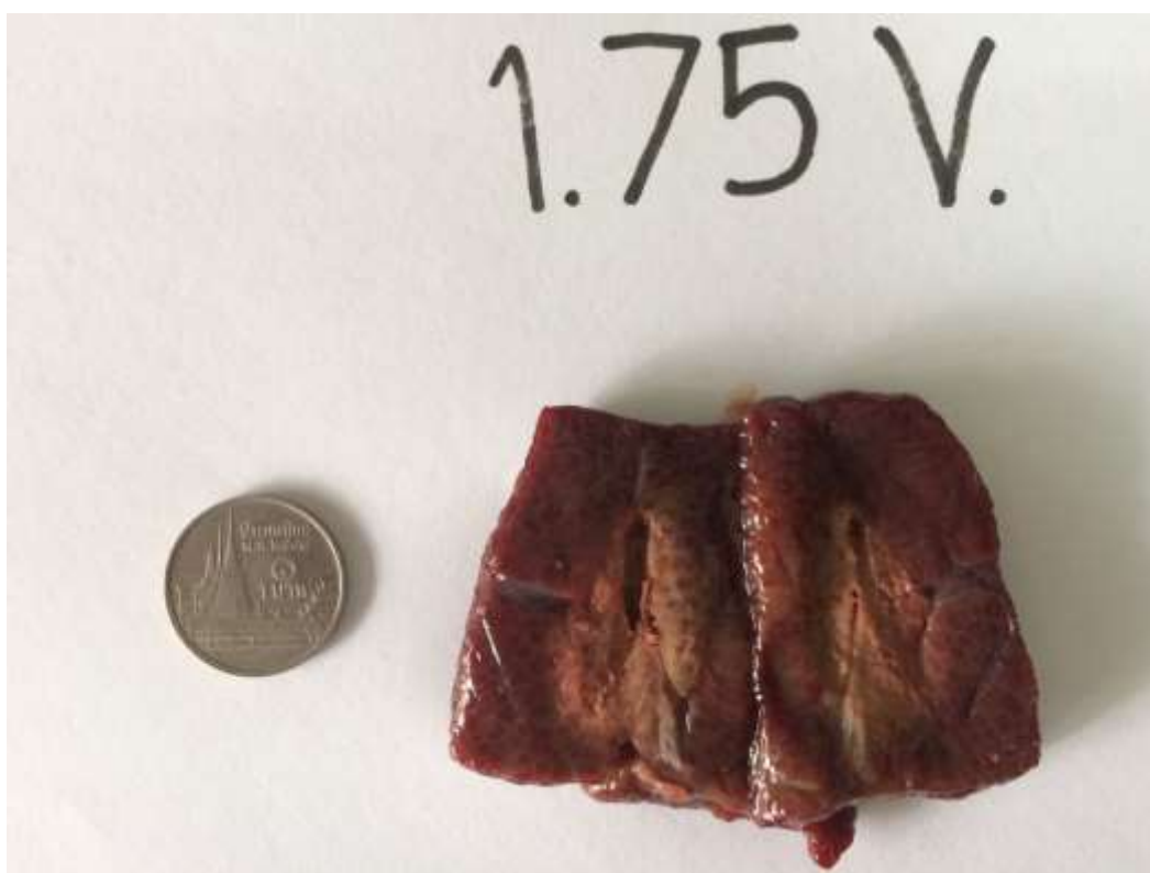
รูปที่ 4.14 การทดลอง โดยทำการทดสอบกับเครื่องทำลายเซลล์มะเร็งขนาด 1 แพล่งจ่าย ปรับกำลังงาน ไฟตรงเพื่อป้อนให้กับชุด จ่ายคลื่นไมโครเวฟขนาด 1.75 โวลท์
