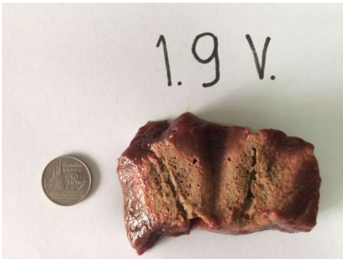
รูปที่ 4.12 การทดลอง โดยทำการทดสอบกับเครื่องทำลายเซลล์มะเร็งขนาด 1 แห่งจ่าย ปรับกำลังงาน ไฟตรงเพื่อป้อนให้กับชุด จ่ายคลื่นไมโครเวฟขนาด 1.9 โวลท์
