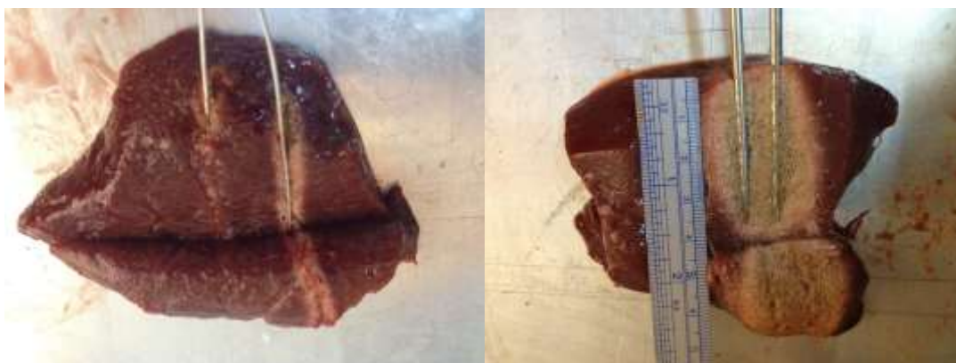
รูปที่ 4.10 (ก) เนื้อเยื่อตับที่ทดสอบกับเครื่องไมโครเวฟที่มีระบบควบคุม
