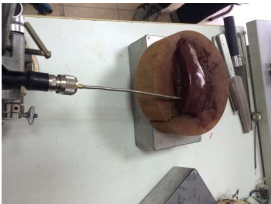
รูปที่ 4.11 การทดลอง โดยทำการทดสอบกับเครื่องทำลายเซลล์มะเร็งขนาด 1 แหล่งจ่าย
