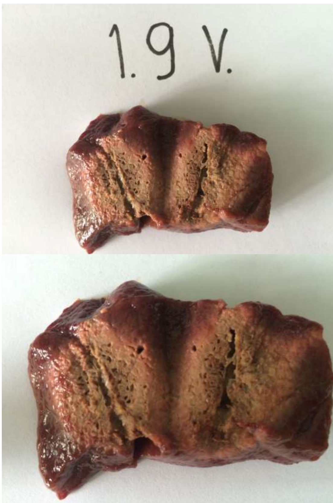
รูปที่ 4.11 การทดลอง โดยทำการทดสอบกับเครื่องทำลายเซลล์มะเร็งขนาด 1 แหล่งจ่าย ปรับกำลังงาน ไฟตรงเพื่อป้อนให้กับชุด จ่ายคลื่นไมโครเวฟขนาด 1.9 โวลท์
