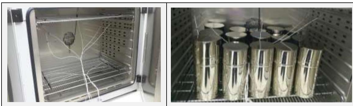
รูปที่ 41 การวางเครื่องมือวัดอุณหภูมิ ตามตำแหน่งต่างๆใน chamber ของเครื่อง Hot air oven เมื่อทำการศึกษา Load Chamber Temperature Distribution
