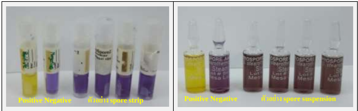
รูปที่ 38 ผลที่ได้จากการตรวจสอบของตัวอย่าง spore strip, spore suspension, positive และ negative control
