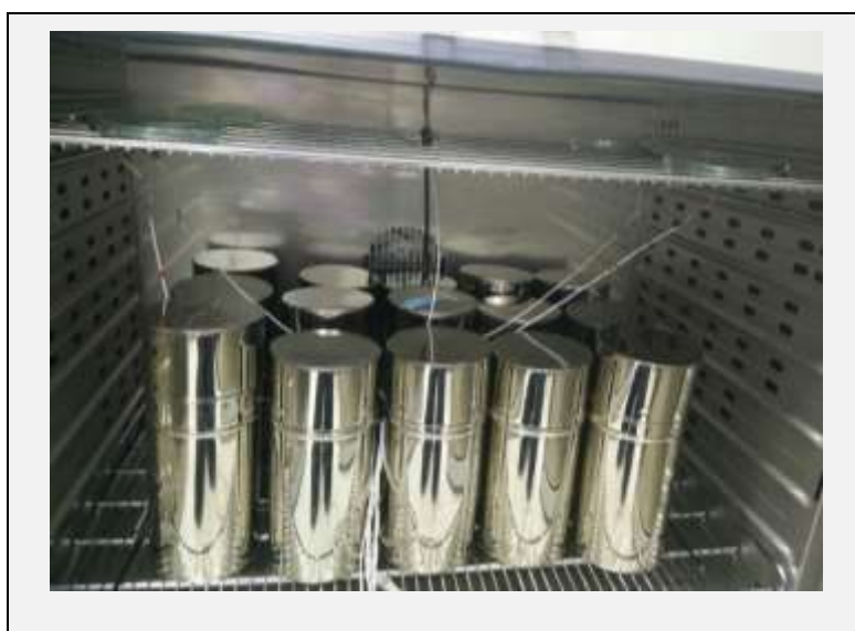
รูปที่ 42 การวางเครื่องมือวัดอุณหภูมิ ตามตำแหน่งต่างๆใน chamber ของเครื่อง Hot air oven เมื่อทำการศึกษา Heat Penetration แบบ Maximum load
