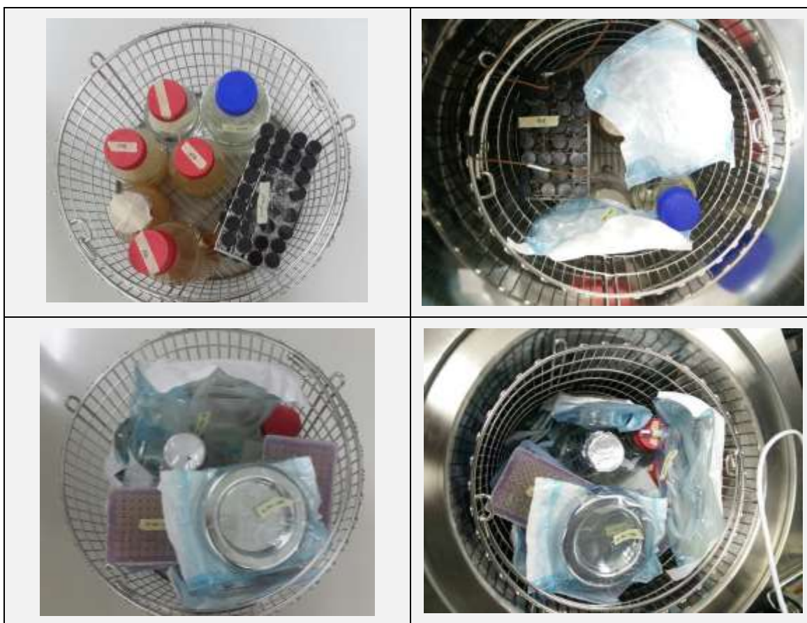
รูปที่ 33 การวางเครื่องมือวัดอุณหภูมิ ตามตำแหน่งต่างๆใน chamber ของเครื่อง Autoclave เมื่อทำการศึกษา Heat Penetration
