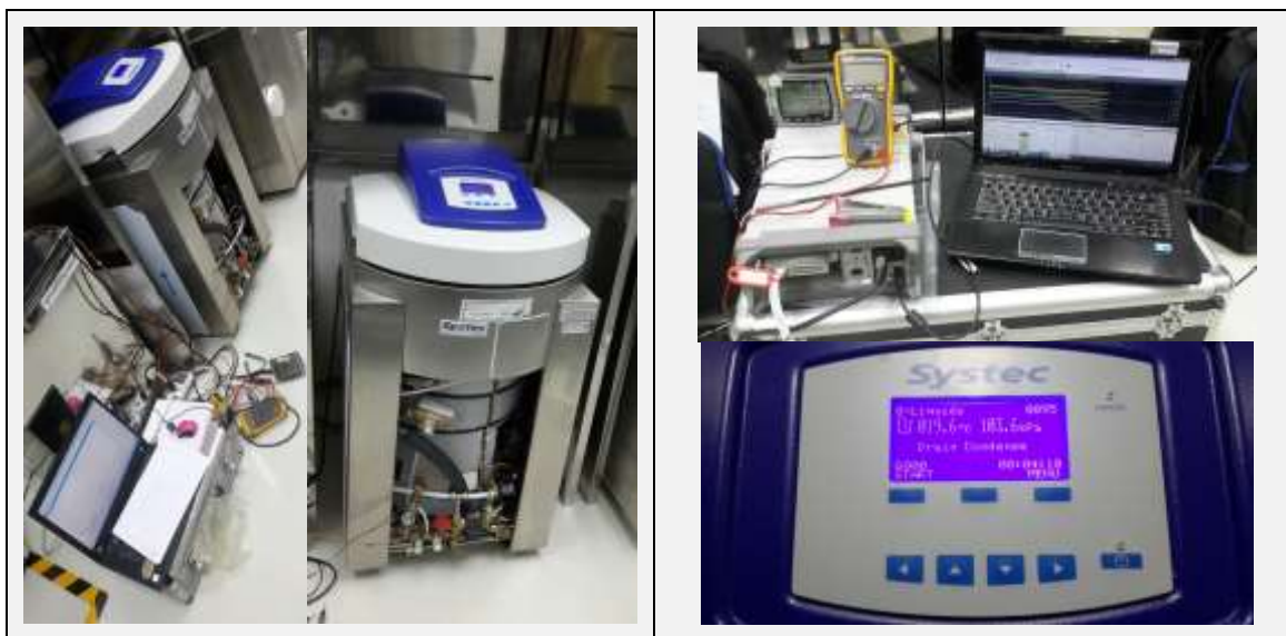
รูปที่ 31 ดำเนินการทำให้ปราศจากเชื้อในช่วง sterilization cycle คือ 121 องศาเซลเซียส เป็นเวลาอย่างน้อย 15 นาที เมื่อทำการศึกษา Empty Chamber Temperature Distribution
