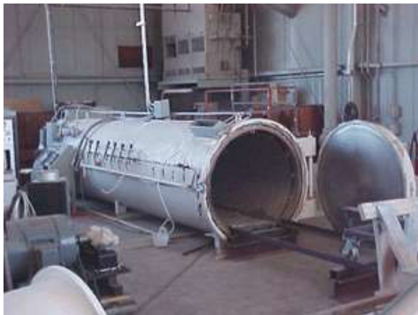
รูปที่ 5 Autoclave แบบมีระบบดูดให้เป็นสุญญากาศ
