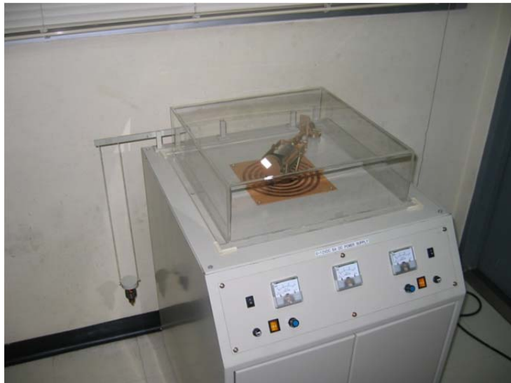
รูปที่ 1 ชุดทดลองปรากฏการณ์ไจโรสโคป (Gyroscope Apparatus)
