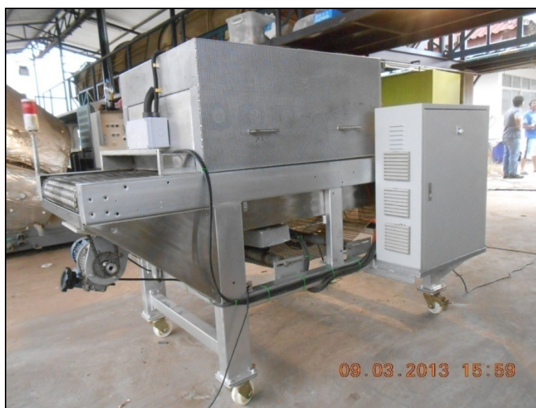
(ข) เตาอบไมโครเวฟร่วมกับลมร้อนร่วมกับลมร้อนด้านข้าง 2
