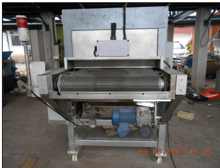
(ข) เตอบไมโครเวฟร่วมกับลมร้อนร่วมกับลมร้อนด้านหลัง
