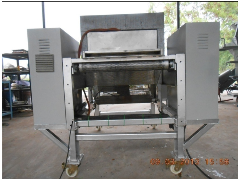
(ก) เตอบไมโครเวฟร่วมกับลมร้อนร่วมกับลมร้อนด้านหน้า
