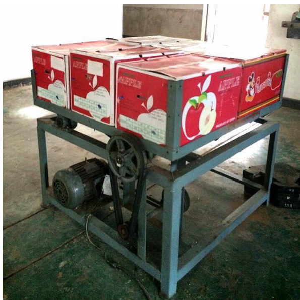
รูปที่ 3.10 การทดสอบภายใต้สภาวะการสั่นสะเทือนจำลอง
