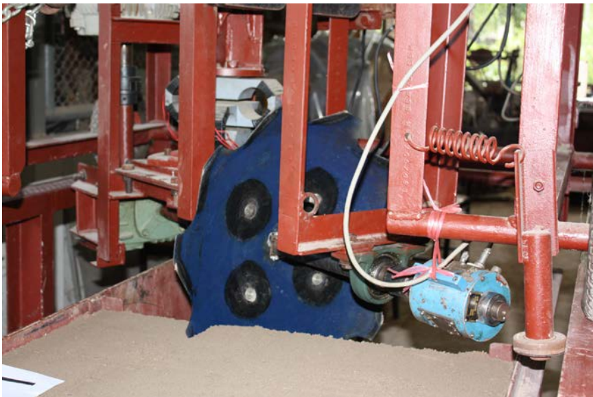
รูป 3.17 การทดสอบ spiral notched disc
