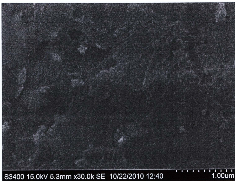
รูปที่ 4.4 ภาพถ่ายตัวเร่งปฏิกิริยาที่ยังไม่ได้ใช้งานจาก SEM ด้วยกำลังขยาย 30000 เท่า
