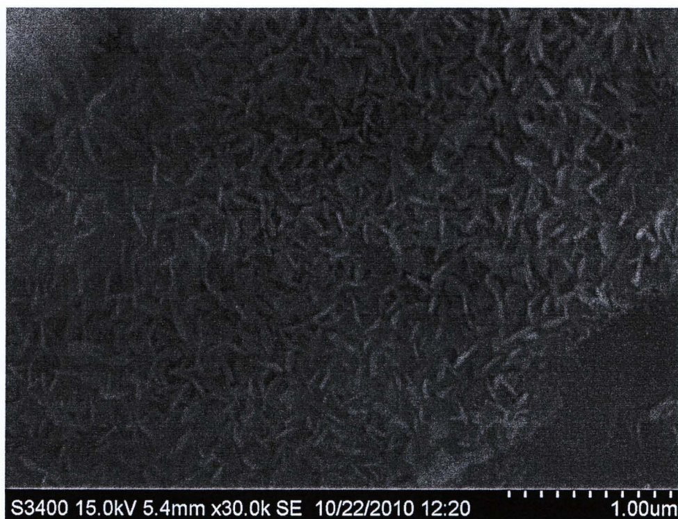
รูปที่ 4.9 ภาพถ่ายตัวเร่งปฏิกิริยาผ่านการใช้งานแล้วจาก SEM ด้วยกำลังขยาย 30000 เท่า
