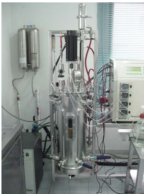
ภาพที่ 2 ถังหมักขนาด 20 ลิตร ที่ใช้ในขั้นตอนการศึกษาการผลิตแบคทีเรียบีที JC590
