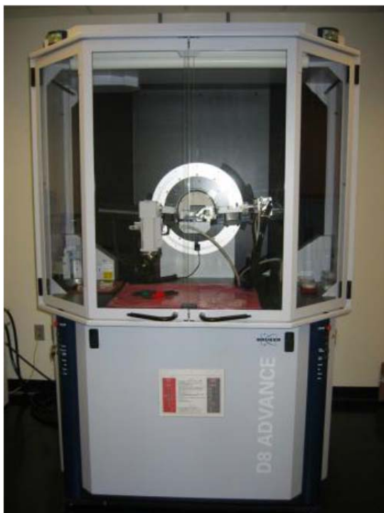
รูปที่ ข.1 อุปกรณ์ X-ray diffraction (XRD) รุ่น Bruker model D8 Advance สภาวะที่ทำการวิเคราะห์ : Cu K \alpha radiation at scan rate of 0.02° S-1
