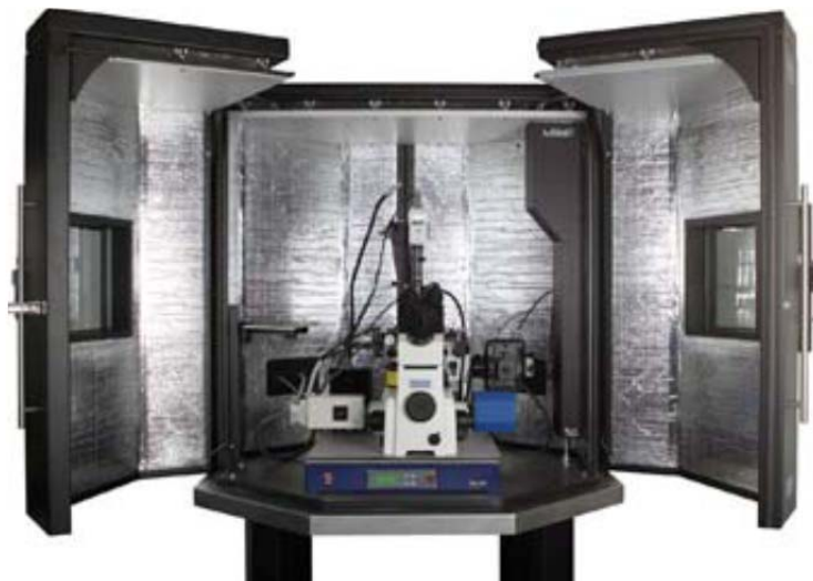
รูปที่ ข.3 อุปกรณ์ Atomic Force Microscopy (AFM) ยี่ห้อ Asylum research รุ่น MFP-3D-BIO™
