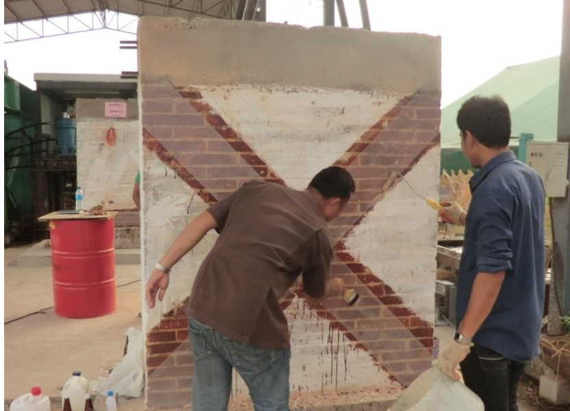
รูปผนวกที่ ข12 ติดตั้ง LVDT
