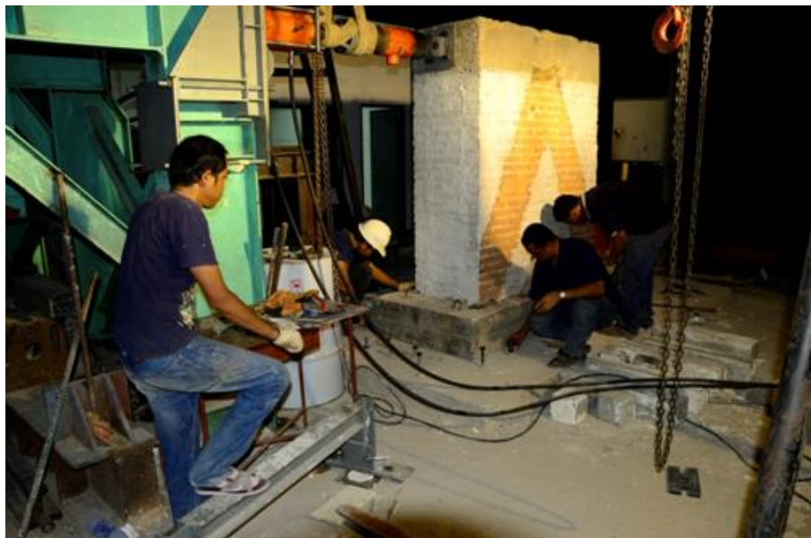
รูปผนวกที่ ข9 จัดวางตำแหน่งเพื่อยึดฐานคอนกรีตเสริมเข้ากับพื้น โดยมีคานเหล็กรัดหัวท้าย
