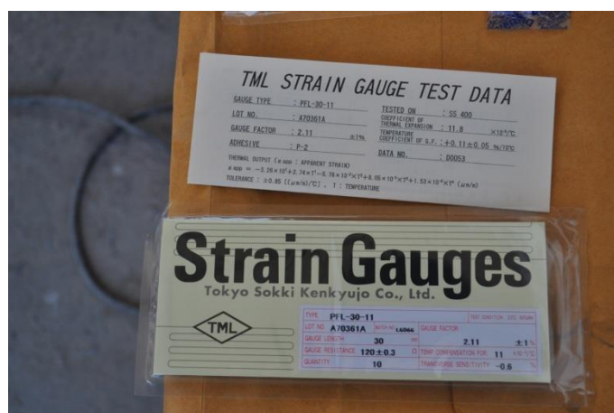
รูปผนวกที่ ๗5 Electric Strain Gages
