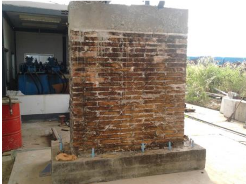
รูปผนวกที่ ข9 จัดวางตำแหน่งเพื่อยึดฐานคอนกรีตเสริมเข้ากับพื้น โดยมีคานเหล็กรัดหัวท้าย
