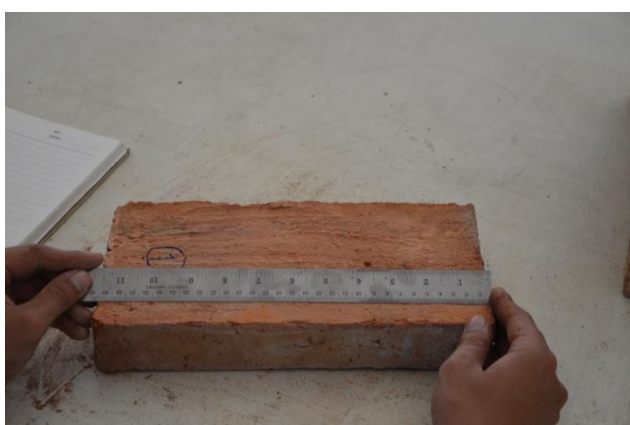
รูปที่ 3.2 การวัดขนาดของอิฐที่ใช้ในการทดสอบ
