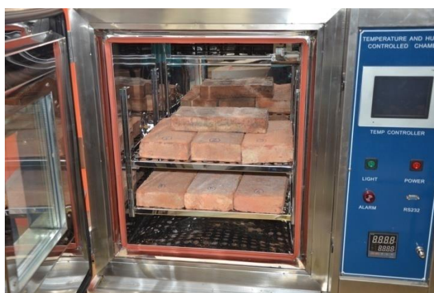
รูปที่ 3.3 การทดสอบการหาน้ำหนักโดยการอบแห้ง
