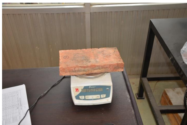
รูปที่ 3.4 การทดสอบการหาน้ำหนักหลังจากการอบแห้ง
