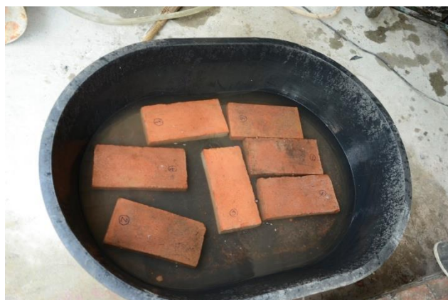
รูปที่ 3.5 การทดสอบการดูดซึมน้ำโดยการแช่น้ำ
