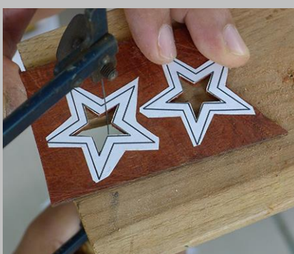
ภาพที่ 21 การใช้เลื่อยฉลุมือ ถ่ายเมื่อวันที่ 16 มกราคม 2555
