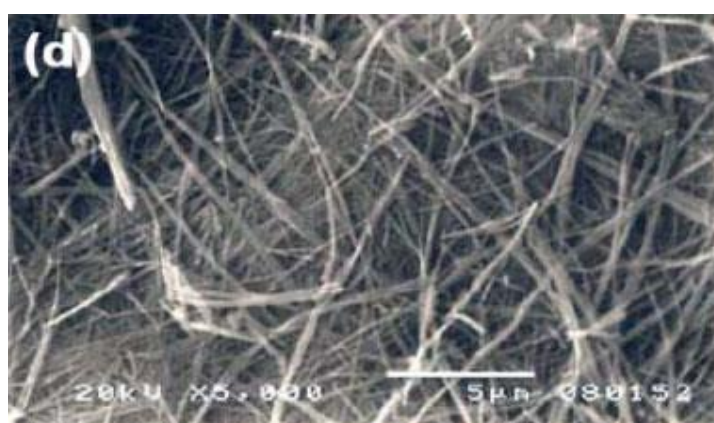
รูปที่ 2.22 รูปถ่ายสัณฐานด้วยกล้องอิเล็กตรอนแบบส่องกราด (SEM) ของ เส้นใยแร่ลูโคซีนานาโน (Leucoxene mineral Nanofiber) กำลังขยาย 5,000 [8]
