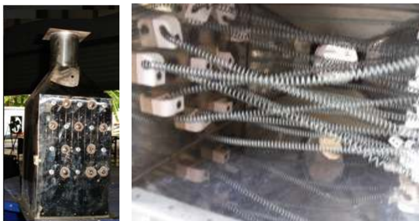
ภาพที่ 3.6 แบบกล่องติดตั้งขดลวดความร้อน
