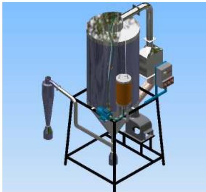
ภาพที่ 3.20 เครื่องอบแห้งน้ำมะนาวแบบผ่านฝอยที่ได้จากการออกแบบ
