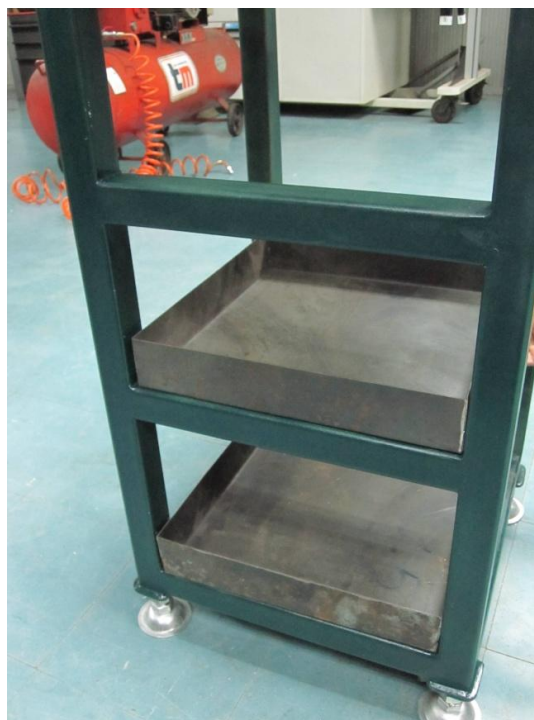
รูปที่ 3.4 แสดงการติดตั้งชั้นสำหรับวางตอกไม้ไฟ
