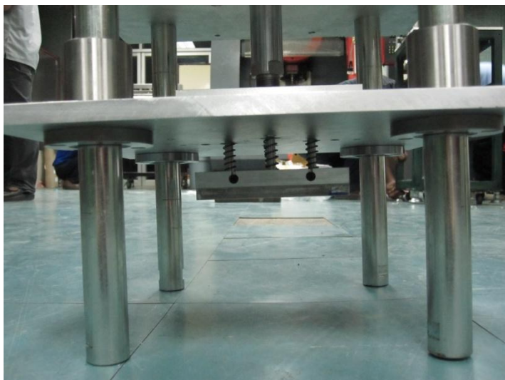
รูปที่ 3.7 แสดงการติดตั้งชุดแผ่นเพลทเลื่อนขึ้นลงได้ (Slide plate)
