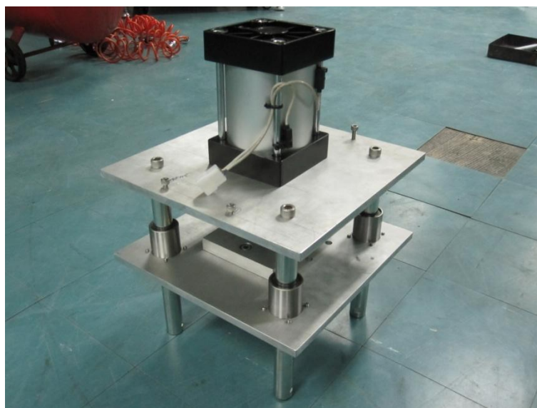
รูปที่ 3.6 แสดงการติดตั้งกระบอกสูบ (Cylinder)
