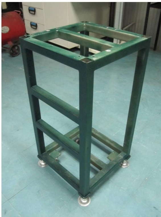
รูปที่ 3.3 แสดงโครงเครื่องหลังจากทำการเชื่อมและพ่นสี
