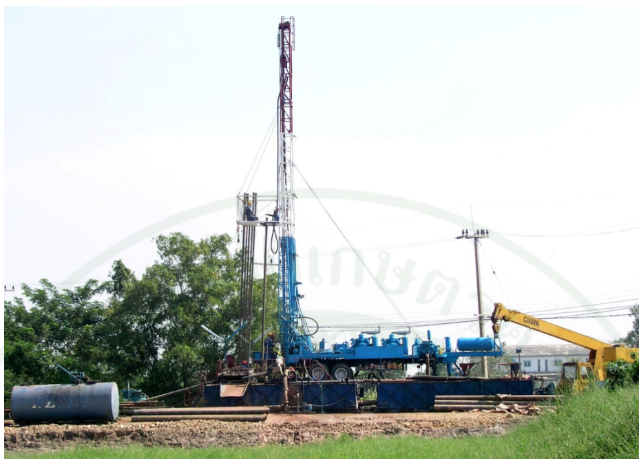
ภาพที่ 79 แท่นเจาะสำรวจและเก็บตัวอย่างดินในระดับลึก
