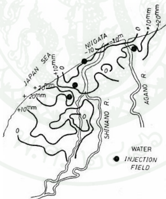
ภาพที่ 38 การทรุดตัวและการฟองตัวของชั้นดินในช่วงระหว่างปี 1973-1974
