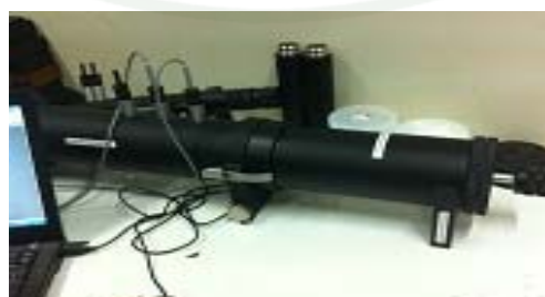
ภาพที่ 37 เครื่องทดสอบคุณสมบัติการดูดซับเสียง (Acoustic Material Testing)
