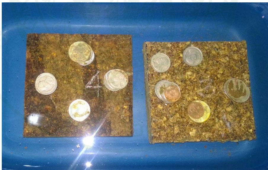
ภาพที่ 45 การนำชิ้นตัวอย่างแช่ในน้ำสะอาดที่อุณหภูมิห้อง
