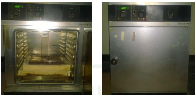
ภาพที่ 40 นำชิ้นตัวอย่างเข้าอบความร้อนในตู้อบที่อุณหภูมิ 105 องศาเซลเซียส นาน 24 ชั่วโมง
