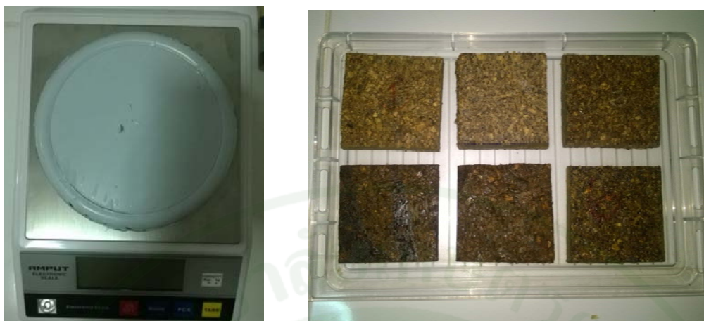
ภาพที่ 46 การนำชิ้นตัวอย่างที่แช่น้ำสะอาดมาวัดขนาด และชั่งน้ำหนัก
