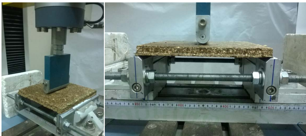
ภาพที่ 48 ขั้นตอนตัวอย่างทดสอบในเครื่องกดและอ่านค่าความต้านทานแรงดัดและค่ามอดุลัสยืดหยุ่น
