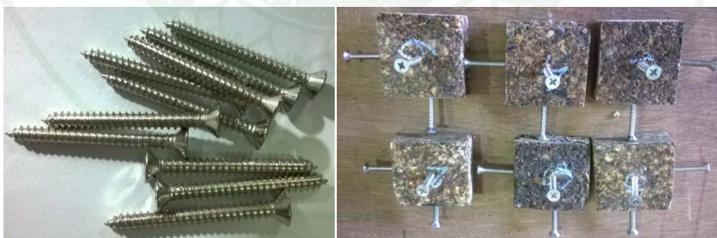
ภาพที่ 51 ตะปูเกลียว ขนาด ความยาว 40 มม. ชิ้นตัวอย่างขันตะปูเกลียวลงในชิ้นตัวอย่าง 3 แห่ง ที่กึ่งกลางผิวหน้า 1 แห่งและที่กึ่งกลางของขอบ 2 ขอบที่ประชิดกัน
