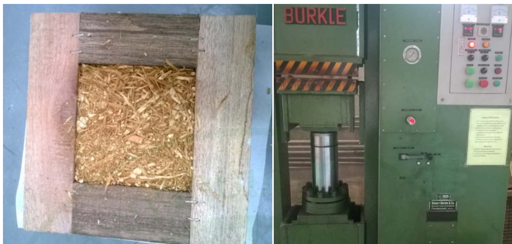
ภาพที่ 32 ใส่ส่วนผสมทั้งหมดลงในแม่แบบอัดในเครื่องอัดความร้อน
