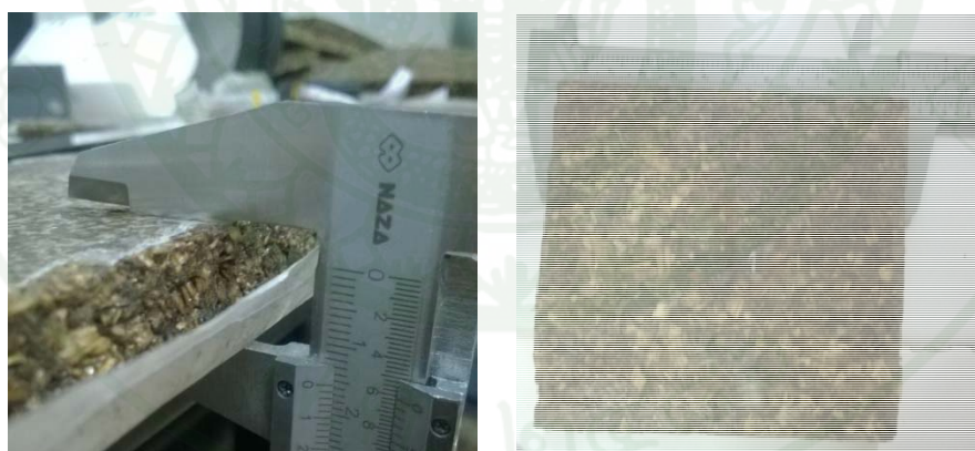
ภาพที่ 43 วัดขนาดดินตัวอย่างด้วยเครื่องมือวัดเวอร์เนียคาร์ลิปเปอร์ที่มีความละเอียด 0.05 มม.
