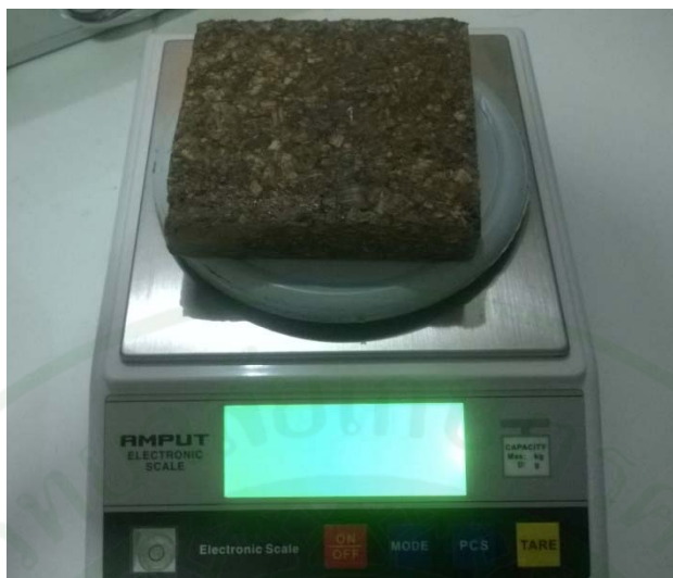
ภาพที่ 44 การชั่งน้ำหนักชิ้นตัวอย่างด้วยเครื่องมือชั่งที่มีความละเอียด 0.01 กรัม
