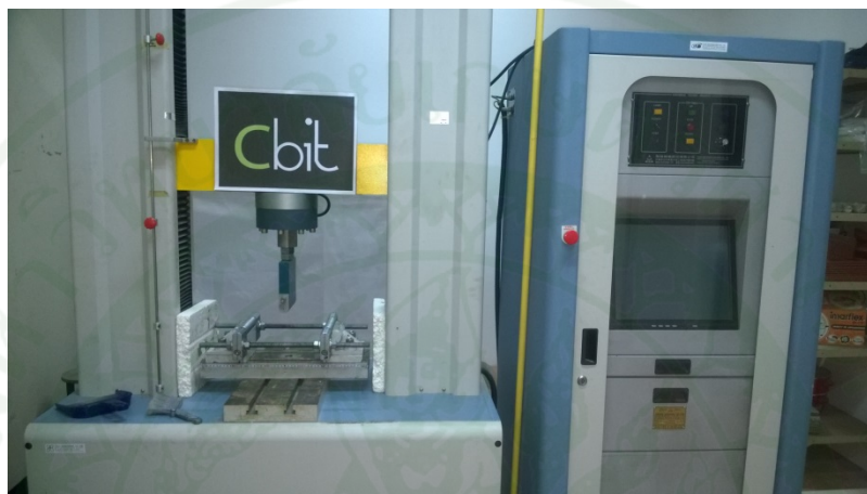
ภาพที่ 23 เครื่องทดสอบการรับกำลังแรงอัด
