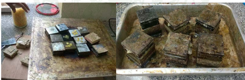
ภาพที่ 49 ขั้นตอนตัวอย่างติดกาวสังเคราะห์กับแป้นเหล็กทดสอบแรงดัด
