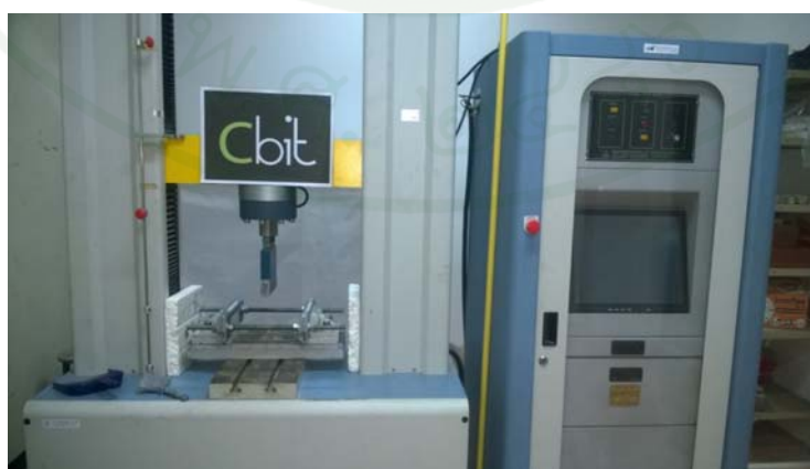
ภาพที่ 47 เครื่องกดทดสอบค่าความต้านทานแรงดัดและมอดูลัสยืดหยุ่น
