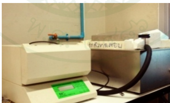
ภาพที่ 24 เครื่องทดสอบเพื่อหาค่าสัมประสิทธิ์การนำความร้อน
