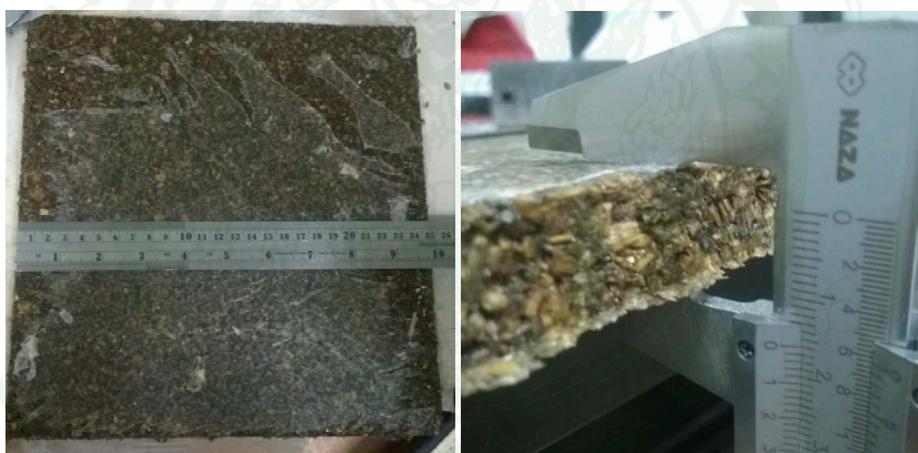
ภาพที่ 33 แผ่นตัวอย่างเมื่ออัดความร้อนเรียบร้อยแล้ว
