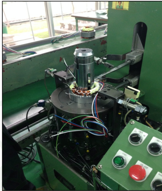
ภาพที่ 14 ภาพการวางชิ้นงานบริเวณแท่นใส่ชิ้นงาน
