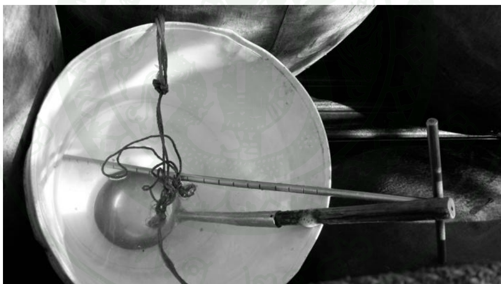
ภาพที่ 14 แท่งสแตนเลสมีขีดบอกระดับ อุปกรณ์สำหรับการวัดปริมาณน้ำตาลไสรในถัง
