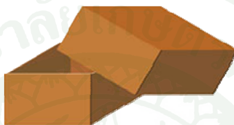
ภาพที่ 3.5 กล่องฝาครอบ (Full Telescope Design Style Box: FTD)
