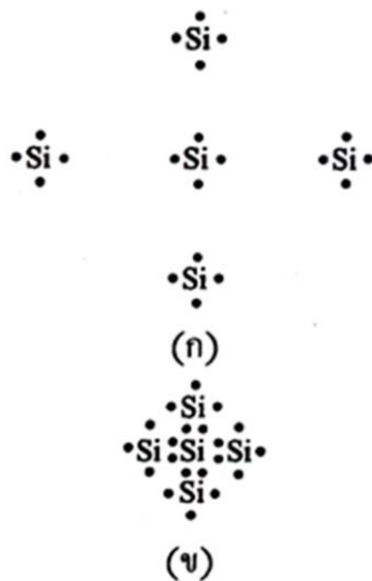
รูปที่ 2.6 (ก) วาเลนซ์อิเล็กตรอนของซิลิคอน และ (ข) พันธะโควาเลนต์ในผลึกซิลิคอน
