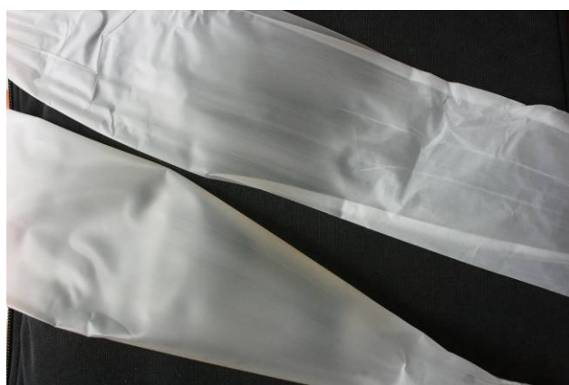
ภาพที่ 9 ลักษณะปรากฏของฟิล์มวัสดุผสม 25G-TPS(60)/EVOH(40) ที่ขึ้นรูปด้วยกระบวนการเป่าขึ้นรูปฟิล์ม
