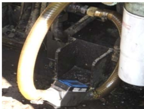
รูปที่ 3.14 การติดตั้งเครื่องวัดอัตราการไหลของน้ำมันเชื้อเพลิง
