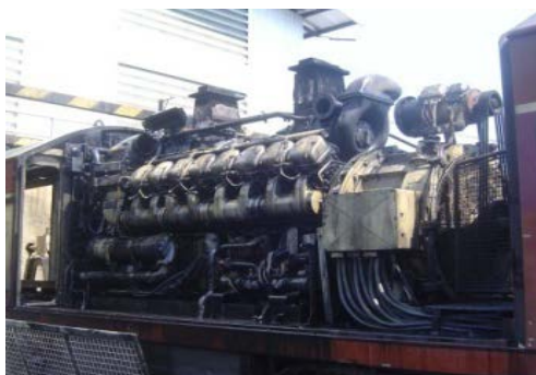
รูปที่ 3.2 เครื่องยนต์ Pielstick 16PA4V185
