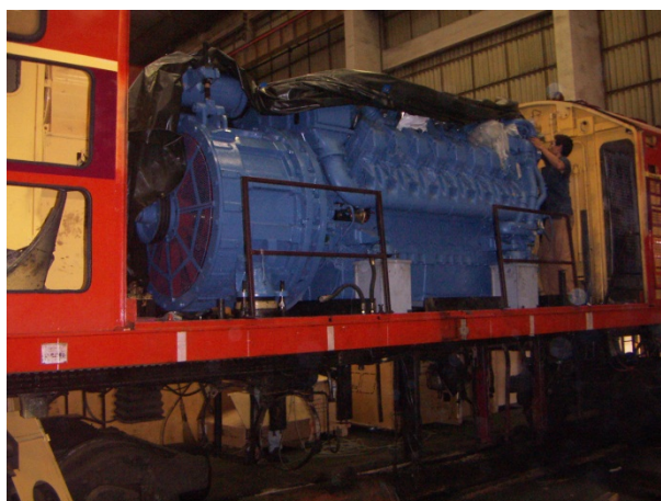
รูปที่ 2.12 เครื่องยนต์ MTU series 16V4000 R41
