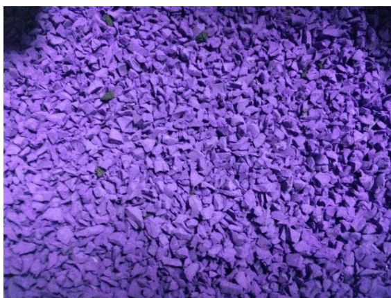
รูปที่ 4.1 ภาพมองด้วยตาเปล่าของเศษพลาสติกอีวีเอที่ผ่านการบดแล้ว
