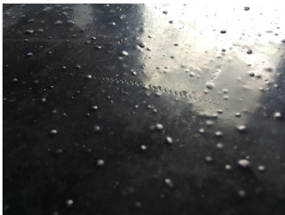
รูปที่ 4.9 ภาพมองด้วยตาเปล่าของกระเบื้องยางพาราผสมพลาสติกอีวีเอ 80 พีเอชอาร์
