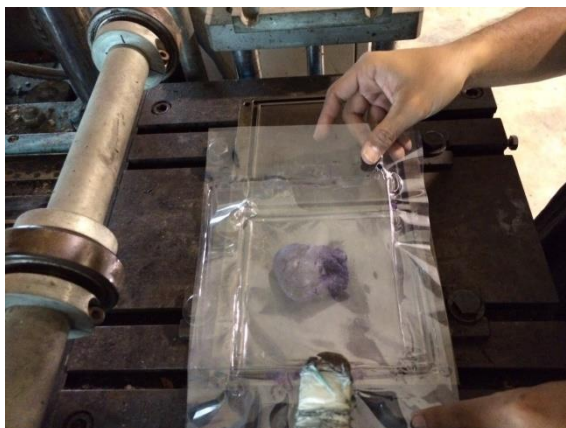
รูปที่ 3.24 นำส่วนผสมใส่ลงในแบบหล่อที่รองด้วยแผ่นพลาสติกสำหรับป้องกันการติดแบบของส่วนผสม
