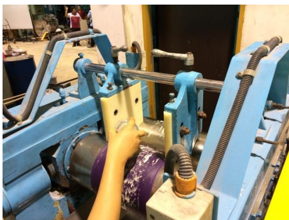
รูปที่ 3.22 การผสมสารตัวเติมลงในยางพารา
