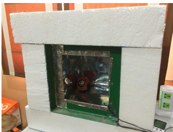
รูปที่ 3.20 การติดตั้งอุปกรณ์ต่างๆ ในห้องจำลองสำหรับทดสอบประสิทธิภาพการป้องกันเสียง
