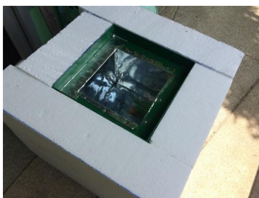
รูปที่ 3.19 ห้องจำลองสำหรับติดตั้งแผ่นวัสดุทดสอบเสียง
