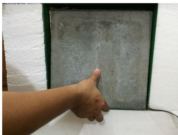
รูปที่ 3.43 การติดตั้งแผ่นคอนกรีตสำหรับทดสอบประสิทธิภาพการป้องกันเสียงของแผ่นกระเบื้องยางพาราผสมพลาสติกอีวีเอ
