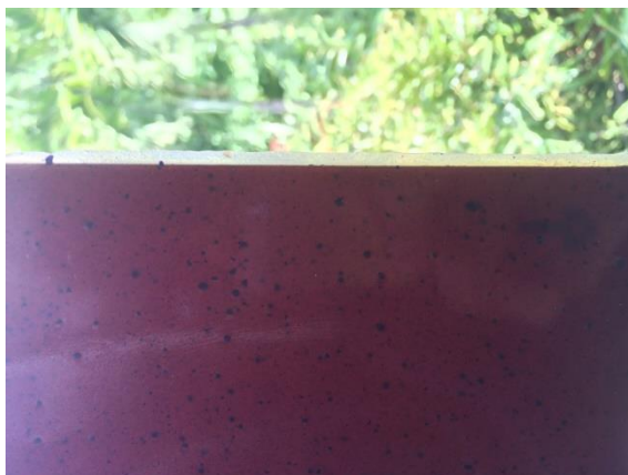
รูปที่ 3.30 การกระจายของพลาสติกอีวีเอในแผ่นกระเบื้องยางพารา
