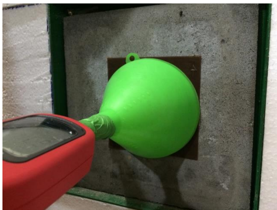
รูปที่ 3.44 การทดสอบประสิทธิภาพการป้องกันเสียงของแผ่นกระเบื้องยางพาราผสมพลาสติกอีวีเอ
