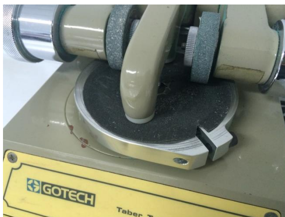
รูปที่ 3.41 การทดสอบการสึกหรอของแผ่นกระเบื้องยางพาราผสมพลาสติกอีวีเอ
