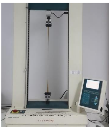
รูปที่ 3.37 การทดสอบความต้านทานแรงดึงของแผ่นกระเบื้องยางพาราผสมพลาสติกอีวีเอ
