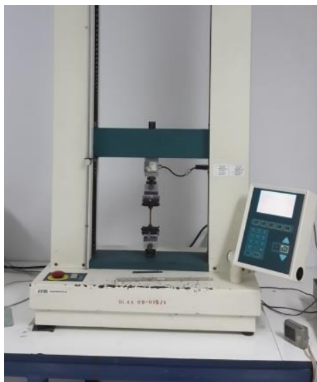
รูปที่ 3.38 การทดสอบความทนการฉีกขาดของแผ่นกระเบื้องยางพาราผสมพลาสติกอีวีเอ
