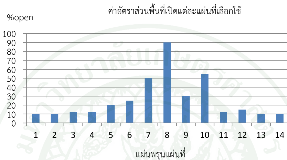
ภาพที่ 59 แผนภูมิแสดงค่าอัตราส่วนพื้นที่เปิดของแผ่นพรุณแต่ละแผ่นที่เหมาะสมที่สุด
