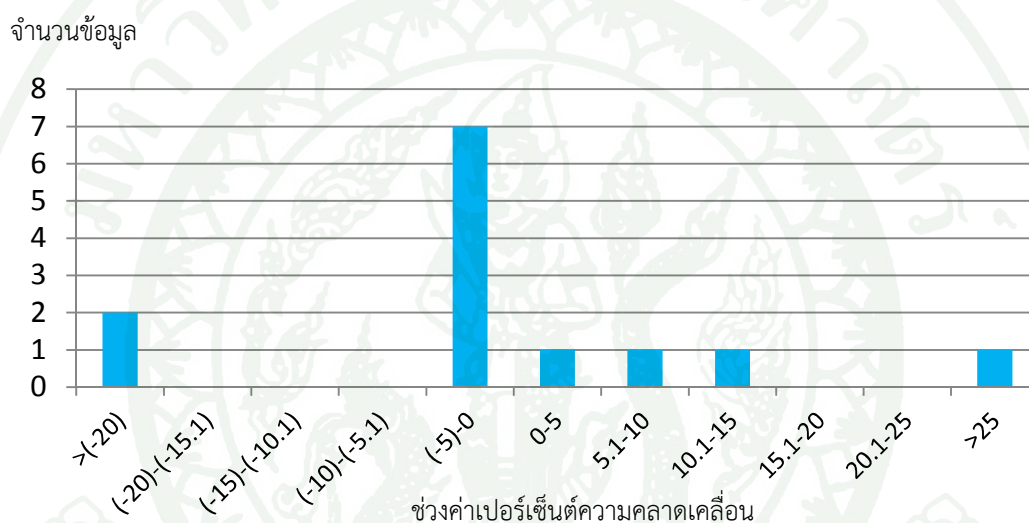
ภาพที่ 37 แผนภูมิแสดงค่าความคลาดเคลื่อนของอัตราการไหลที่ออกจากแผ่นพรุณเปรียบเทียบกับระหว่างการวิเคราะห์กับค่าที่วัดจากการทดลอง
