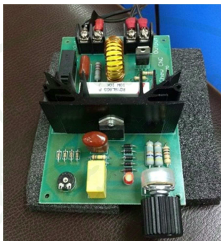
ภาพที่ 21 แสดงรูปชุดปรับความเร็วรอบมอเตอร์
