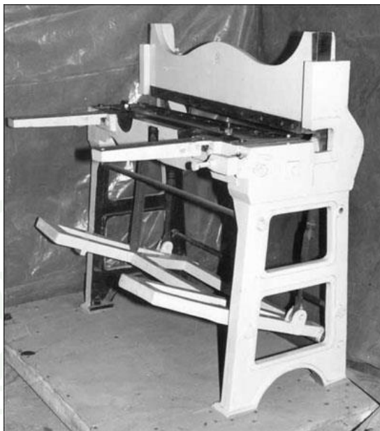
ภาพที่ 8 เครื่องตัดแผ่นเหล็ก (Cutting Machine)
