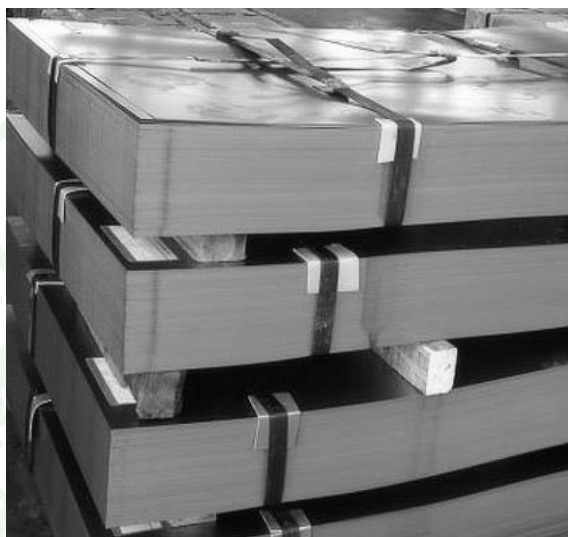
ภาพที่ 6 แผ่นเหล็กเคลือบดีบุก (Tin Plate) ที่มา: Foodnetworksolution (2557)
