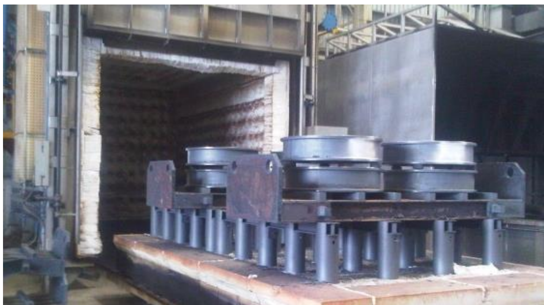
ภาพที่ 54 ให้พลังงานความร้อนกับล้อ (Wheel) ในงานสวมประกอบโดยใช้ในเตาเผาแบบเดิมก่อนปรับปรุง
