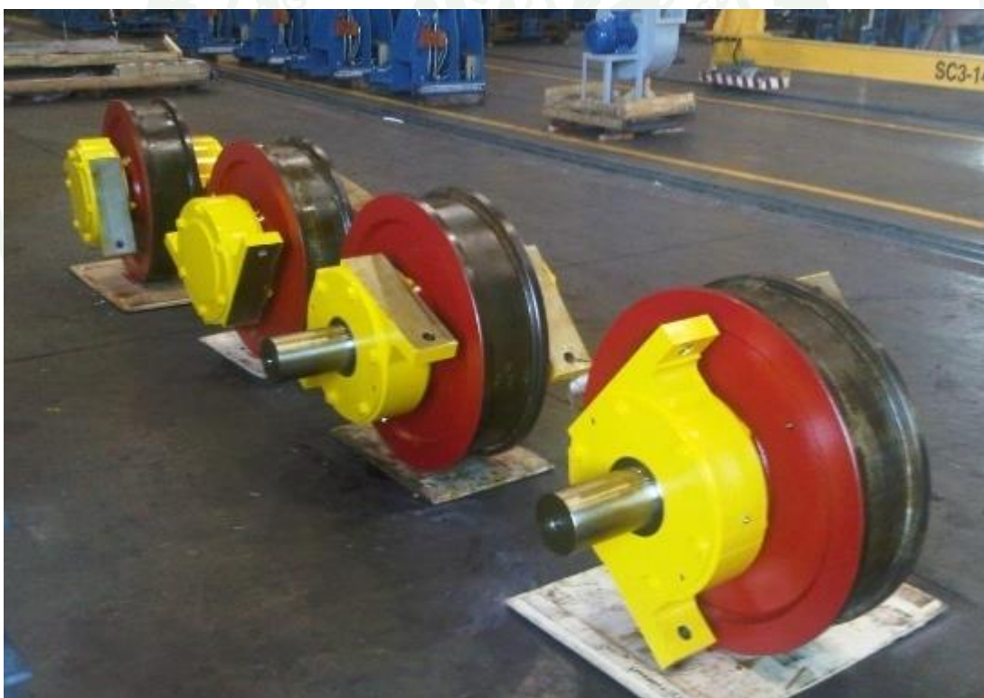
ภาพที่ 58 งานสวมประกอบล้อร่วมกับเพลลาชิ้นสุดท้าย
