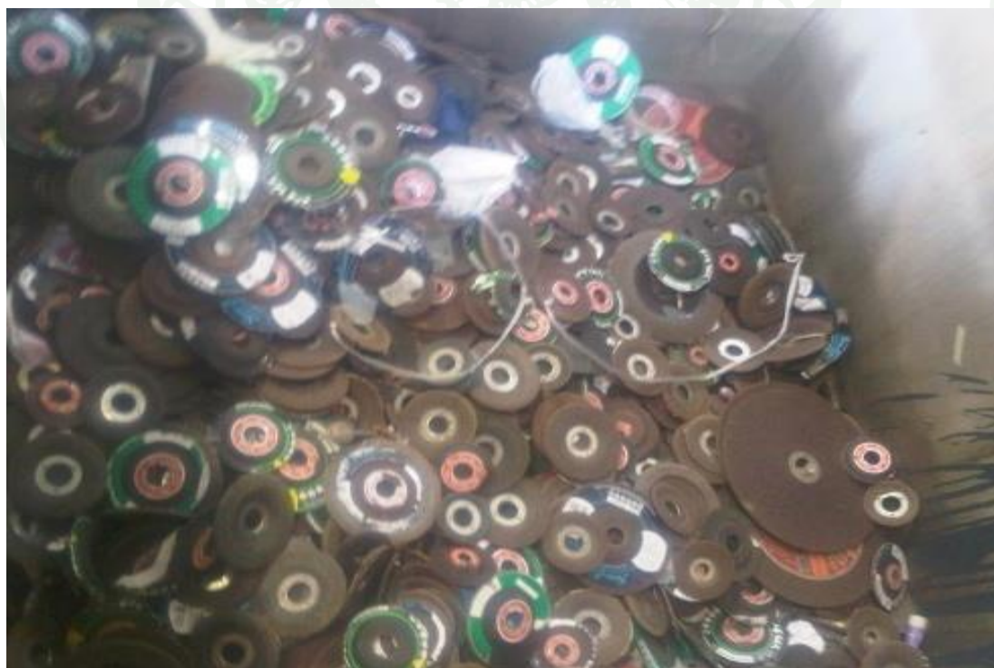
ภาพผนวกที่ ค4 เศษใบหินขัด เจียร (Grinding disc) ที่ใช้งานจากกระบวนการเชื่อม
