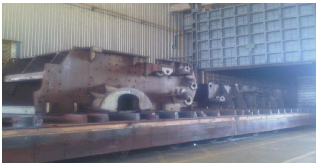
ภาพที่ 23 ชิ้นส่วนเครื่องจักรกลที่ผ่านการอบคลายเครียด
