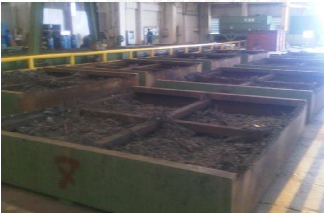
ภาพผนวกที่ ค2 เศษเหล็กชนิดกากตะกอนจากการตัด (Steel Slag)
