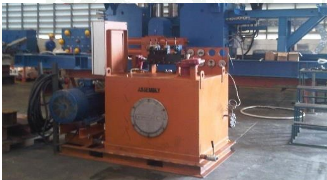
ภาพผนวกที่ ค14 ระบบไฮดรอลิกส์สำหรับงานทดสอบเครื่องจักรหลังการประกอบ
