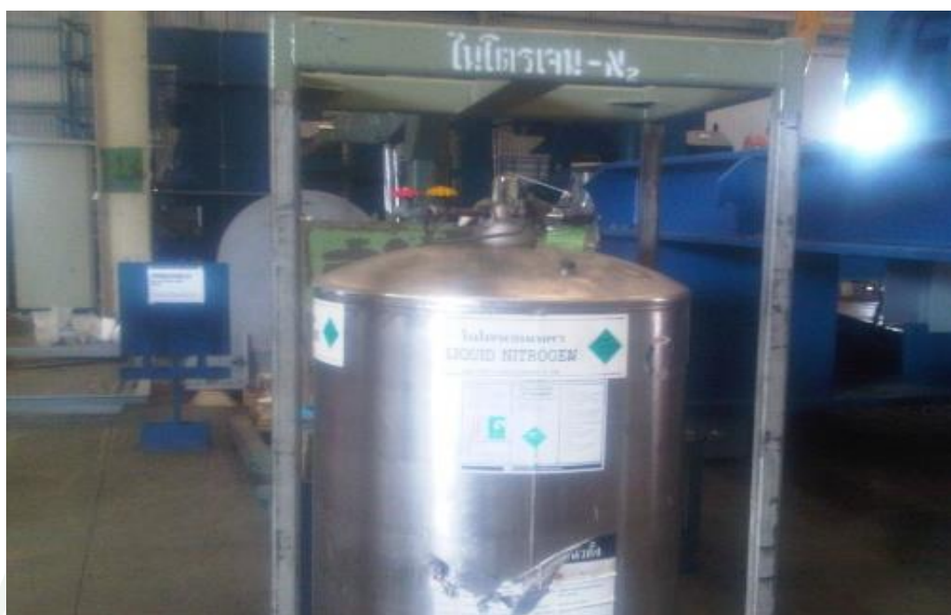
ภาพผนวกที่ ค13 ไนโตรเจนเหลวใช้ในงานสวมประกอบในกระบวนการประกอบชิ้นส่วน
