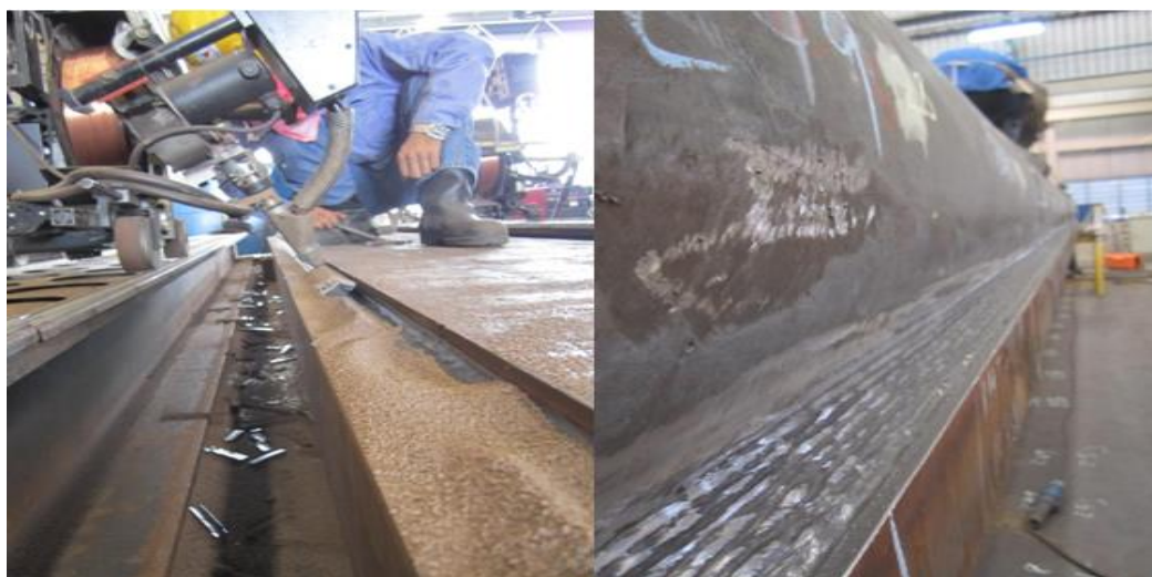
ภาพที่ 20 กระบวนการเชื่อมโดย เครื่องเชื่อมแบบอัตโนมัติ (Automatic Welding Machine)
