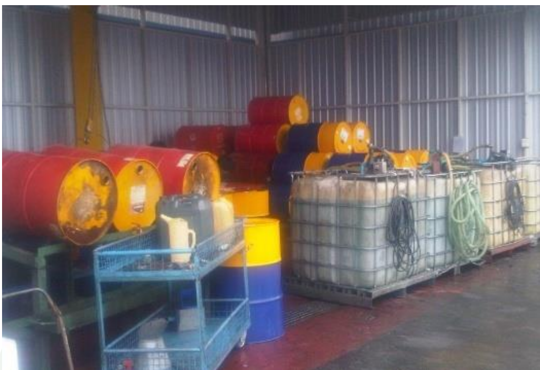
ภาพผนวกที่ ค11 น้ำหล่อเย็นสำหรับหล่อลื่นและระบายความร้อนในกระบวนการปาดผิว
