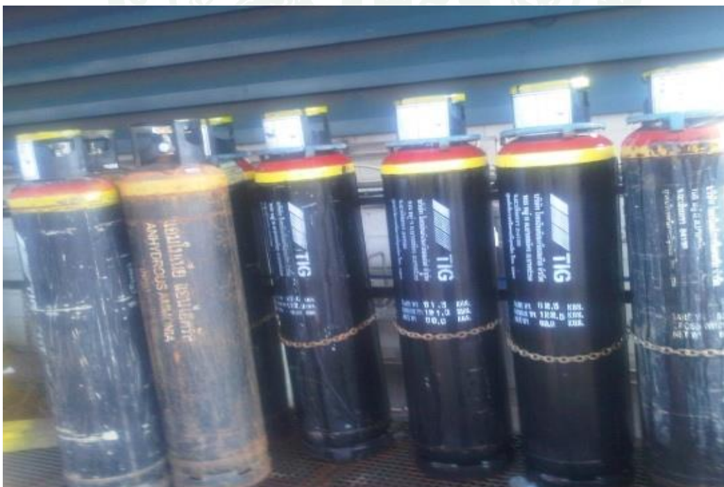
ภาพผนวกที่ ค12 แก๊สแอมโมเนียสำหรับกระบวนการอบชุบแข็งผิวของโลหะ
