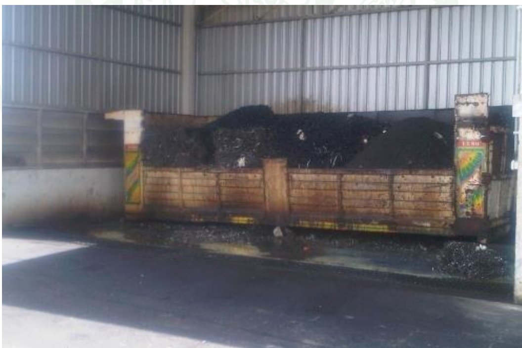
ภาพผนวกที่ ค10 ปริมาณเศษเหล็กจากการปาดผิวชิ้นงาน (Turning Scrap) รอกการจัด
