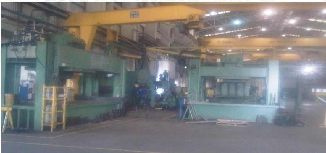
ภาพที่ 16 เตรียมชิ้นงาน โดยเครื่อง คัด พับ และเครื่องตัด
