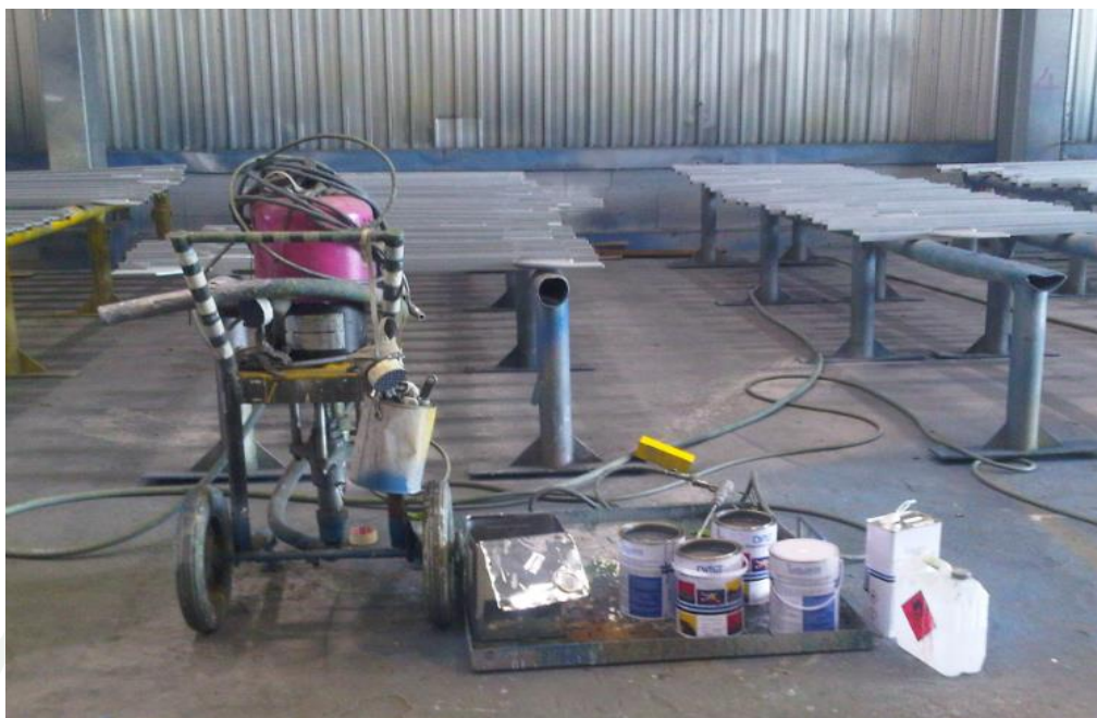
ภาพที่ 30 อุปกรณ์สำหรับการพ่นสี ด้วยเครื่องพ่นสีแรงดันสูง (Airless Spray)
