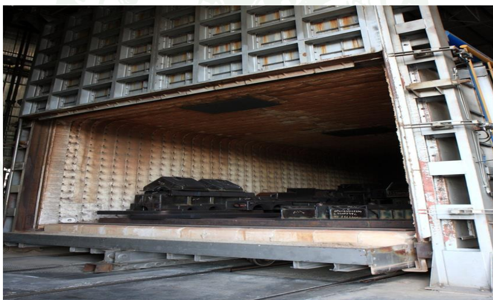
ภาพที่ 22 กระบวนการอบคลายเครียดชิ้นงาน
