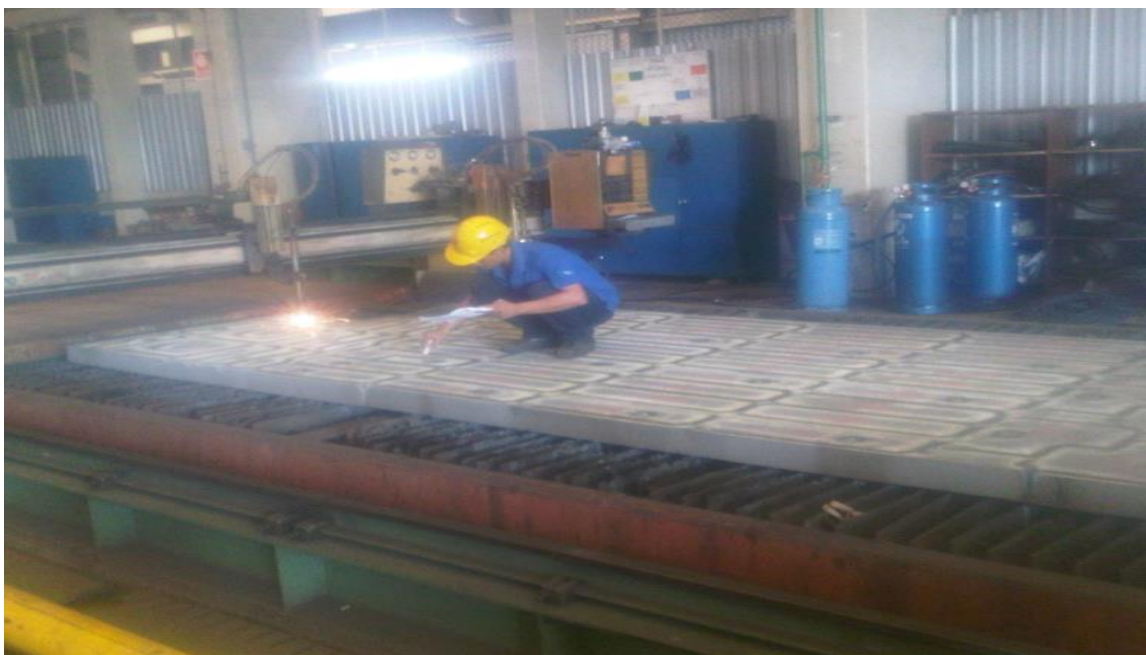
ภาพที่ 15 การตัดชิ้นงาน โดยเครื่องตัด (Oxygen Cutting Machining)
