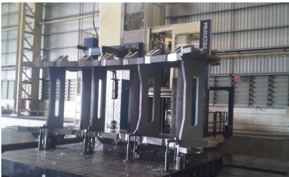
ภาพที่ 33 การจับยึดชิ้นส่วนอุปกรณ์บนเครื่อง ปาดผิว อัตโนมัติ (CNC Milling Machine)
