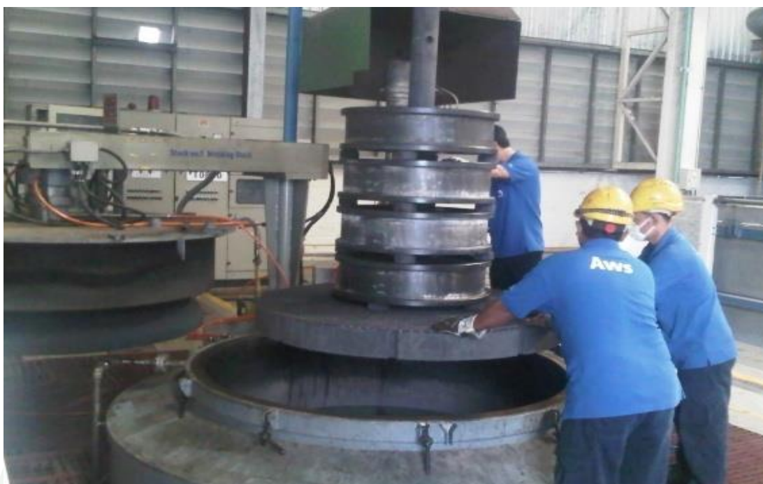
ภาพที่ 55 พนักงานประกอบเตรียมการบรรจุล้อ (Wheel) ลงในภาชนะสำหรับการเตาอบไฟฟ้า ในไตรแบบทรงกระบอกแบบใหม่หลังปรับปรุง
