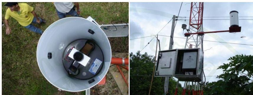
ภาพที่ 16 สถานีตรวจวัดและเครื่องมือตรวจวัดน้ำฝนอัตโนมัติของกรมอุตุนิยมวิทยา
