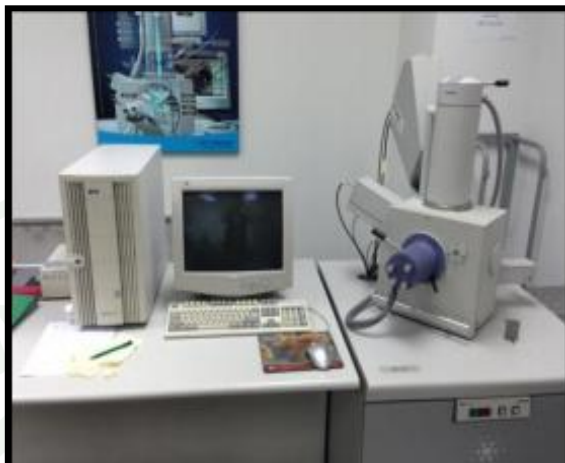
ภาพที่ 18 เครื่องวิเคราะห์โครงสร้างทางจุลภาคของยางพองด้วยเครื่อง SEM
