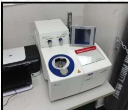
ภาพที่ 17 เครื่องวิเคราะห์การเปลี่ยนแปลงพลังงานความร้อนและอุณหภูมิของสารทำให้เกิดฟองด้วยเครื่อง DSC
