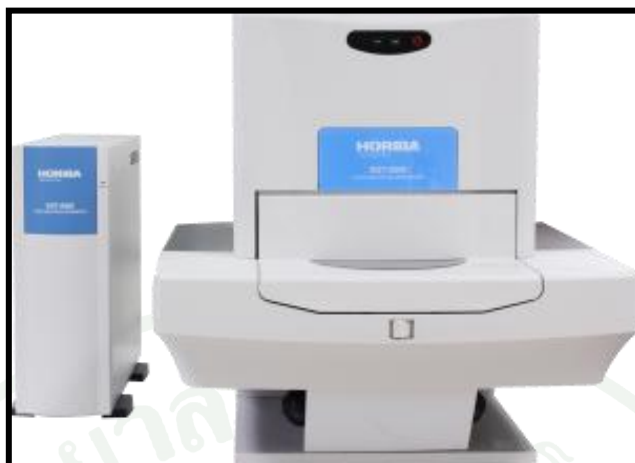
ภาพที่ 21 เครื่องวิเคราะห์การกระจายตัวของสารตัวเติมด้วยเครื่อง XRF
