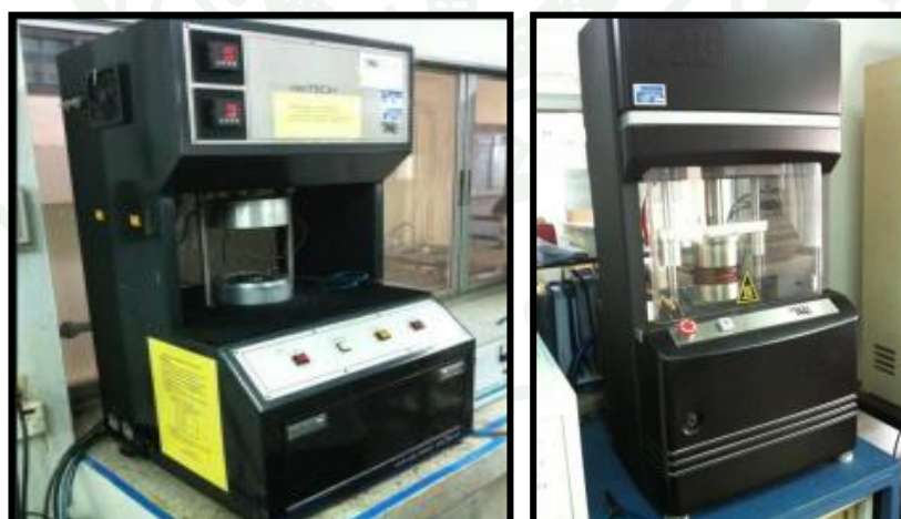
ภาพที่ 16 เครื่องวัดความหนืดมูนนี่ (ซ้าย) และเครื่องทดสอบการคงรูปของยาง (ขวา)
